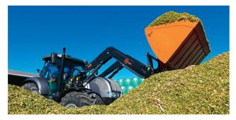
été améliorée. La nouvelle traverse étant alignée sur le champ de vision du conducteur, même les dents des palettes bénéficient d'une excellente visibilité. Sur les gros tracteurs, la visibilité est assurée en option par une caméra frontale montée au centre. Les zones de travail sombres peuvent être éclairées par des projecteurs LED sur le bras oscillant.
