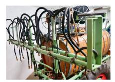
La rampe déployée mesure 6 mètres. Remarquez les deux robinets montés en bas de la face arrière du fût.
