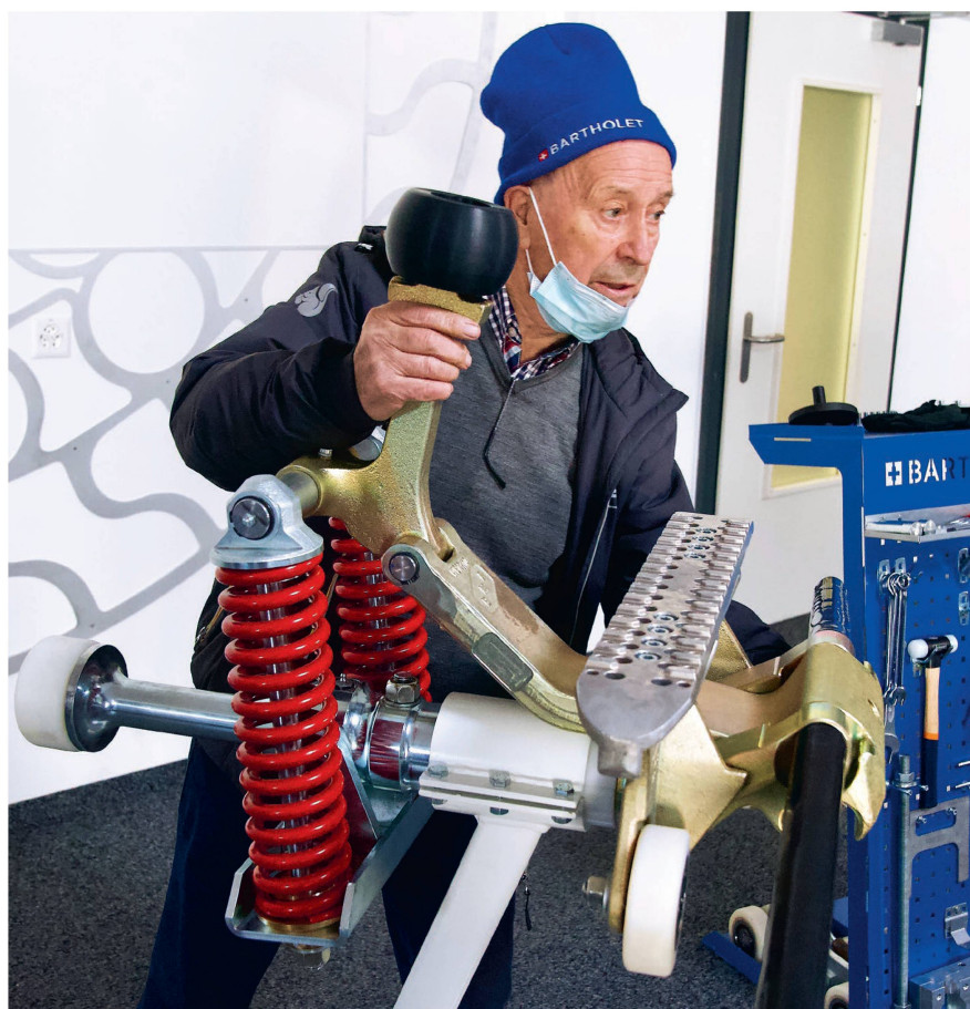
Anton Bartholet montre ici un dispositif de freinage d'une cabine. Il a fait de son atelier mécanique une entreprise d'envergure mondiale. Photos: Dominik Senn
