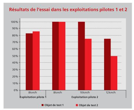
Résultats de l'essai dans l'exploitation pilote 1 (praire artificielle de 50 cm) et dans l'exploitation pilote 2 (prairie artificielle de 60 cm et différentes difficultés pour le passage de véhicules) avec les deux objets de test.
