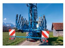
La partie arrière est dotée d'un éclairage pour assurer un transport routier sûr.
