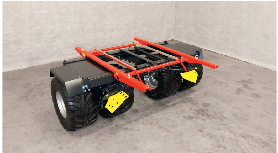
Le train vu de près: les profils en acier couissent sur les éléments en plastique dur lors des mouvements de déploiement et de repli.
