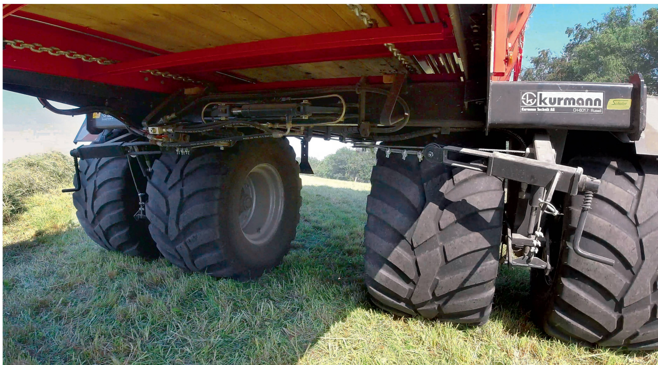
L'essieu oscillant «Super Large» peut se déployer en largeur dans les dévers; son assise gagne jusqu'à 60 cm pour atteindre 314 cm au maximum. Photos: Ruedi Burkhalter
