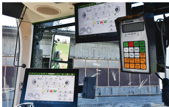
Les outils compatibles Isobus rendent superflus les terminaux d'autres marques. Les tâches sont assurées par le terminal du toit.
