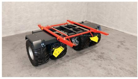
Le train vu de près: les profils en acier coulissent sur les éléments en plastique dur lors des mouvements de déploiement et de repli.
