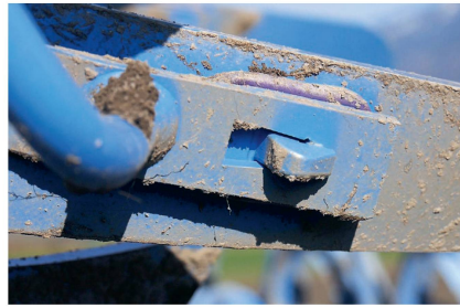
Les corps de charrue sont de type «DuraMaxx»; ils ne sont pas boulonnés et peuvent être simplement insérés dans le sep.
