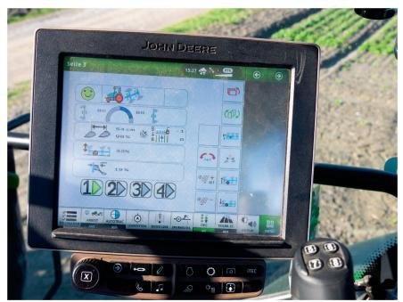
La commande de la charrue s'effectue directement via un terminal Isobus compatible.
