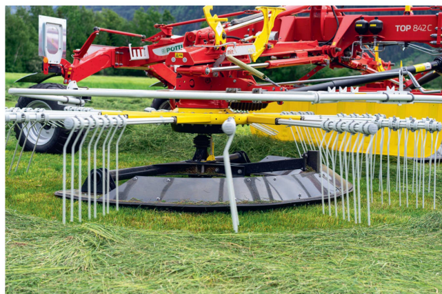
Les pertes générées par l'andaineur restent dans des limites acceptables si le réglage et la vitesse sont corrects. Photo: Pöttinger
