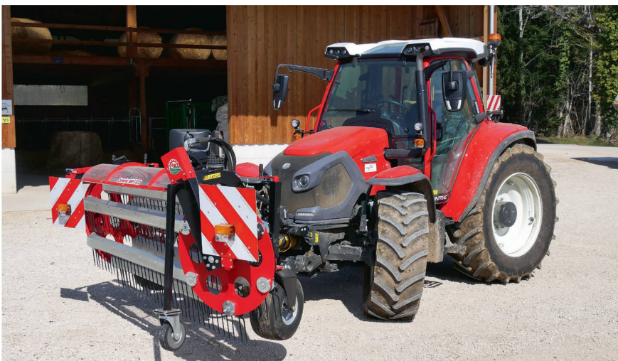
«L'association du «Lintrac 110» avec direction sur les quatre roues et de l'andaineur à peigne constitue un attelage optimal pour les terrains en pente», affirme Christian Rüfenacht.
