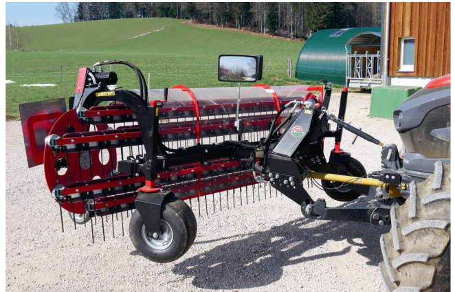
D'un poids de 350 kg seulement, l'andaineur à peigne est monté près du tracteur grâce à la tête d'attelage pivotante. La roue de support avant (photos) permet un stationnement et des déplacements rapides.
