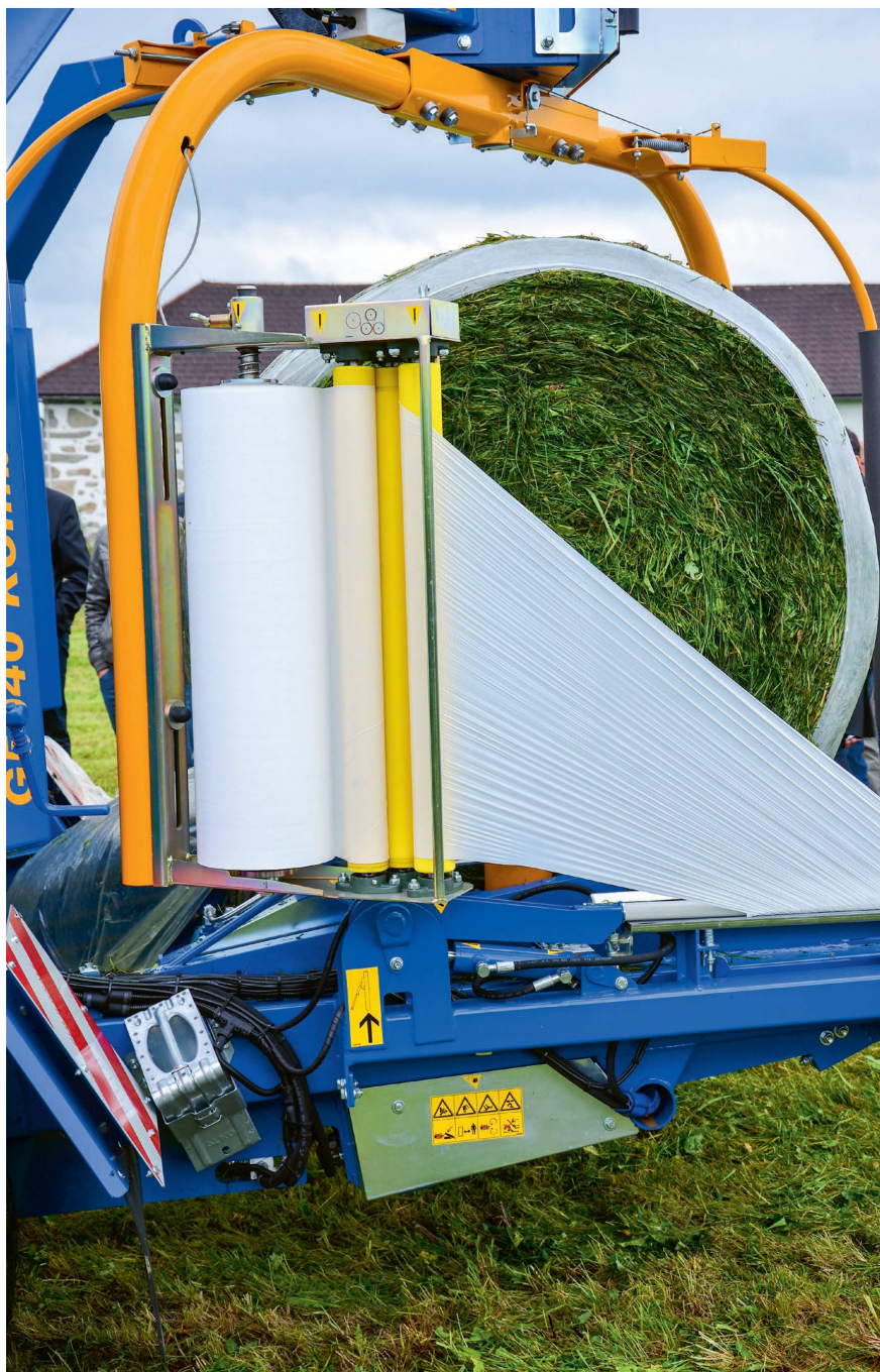
Les films constituent une barrière efficace contre les entrées d'oxygène et doivent résister aux UV pendant au moins 12 mois. Photos: Ruedi Hunger
