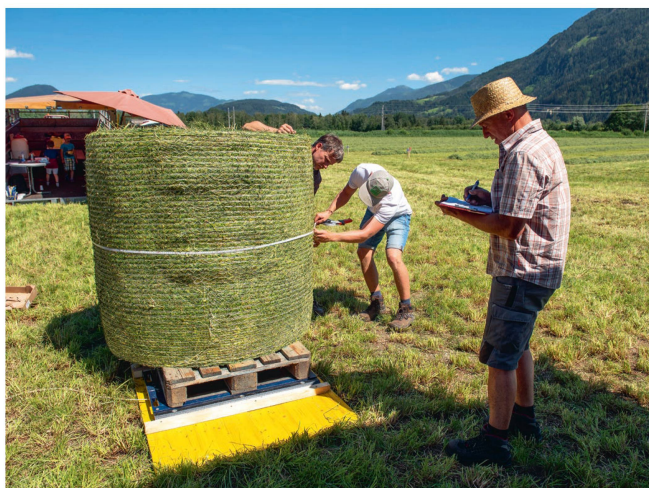
Le BLT Wieselburg a mesuré et pesé précisément les balles pour déterminer leur densité.
