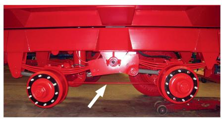
Un train roulant dynamique muni d'une tringle ALB (balance) à laquelle sont reliées les tringles de commande ALB. Sur les trains roulants à suspension parabolique, Krampe installe l'ALB mécanique au centre, entre les deux essieux. Sur les essieux à suspension pneumatique ou hydraulique, la soupape ALB est commandée par la pression exercée sur la suspension. Photo: Krampe
