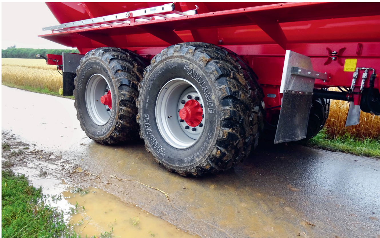
Nombreux sont les essieux tandems de remorques agricoles qui ne freinent pas comme il faudrait sur la route lors de brusques manœuvres de freinage. Photo: Roman Engeler
