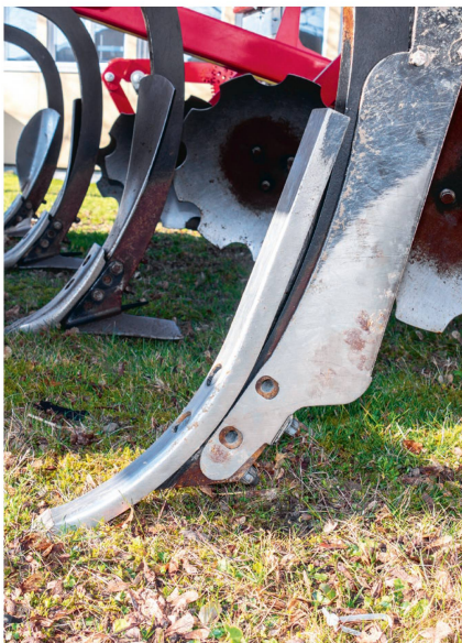
Une dent équipée d'une pointe de soc «MulchMix» et d'un soc «Low-Disturbance».
