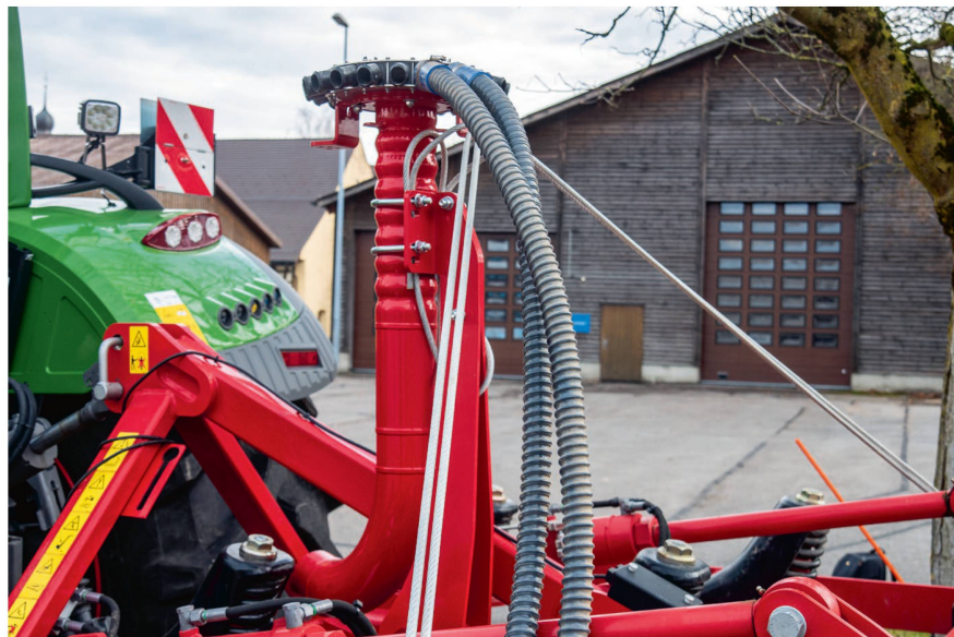
Tête de distribution pour l'engrais avec à chaque fois deux sorties pour chaque dent. Cet équipement peut aussi être utilisé pour déposer un semis intermédiaire.
