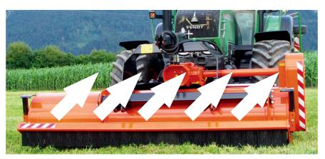
La combinaison d'un broyeur frontal et d'une charrue permet de répartir le mulch sur la surface déjà labourée. Principe de fonctionnement: Ruedi Hunger
