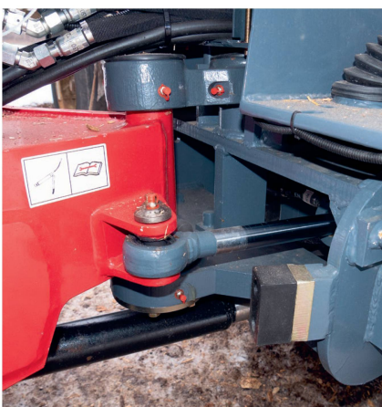
Le véhicule possède une direction articulée oscillante remarquablement robuste.
