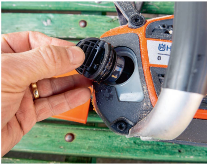
Les écrous imperdables et le bouchon d'huile à poignée flip-up font aujourd'hui partie des équipements standard.
