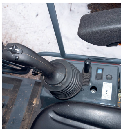
Le joystick assure un dosage très précis des différentes fonctions.
