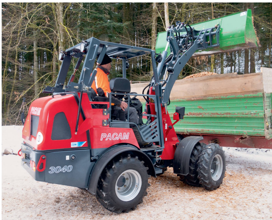
Un valet de ferme Pacam «3040», équipé d'un moteur de 40 chevaux, de roues jumelées et d'un toit de protection rabattable, a été mis à la disposition de Technique Agricole pour une série d'essais pratiques de trois semaines. Photos: Roman Engeler
