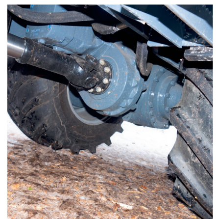
La propulsion se répartit entre les essieux via une boîte de transfert et des cardans.
