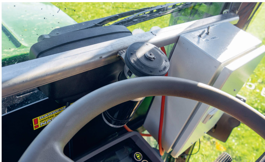
Le moteur d'asservissement du volant installé dans la cabine, juste sous le pare-brise.
