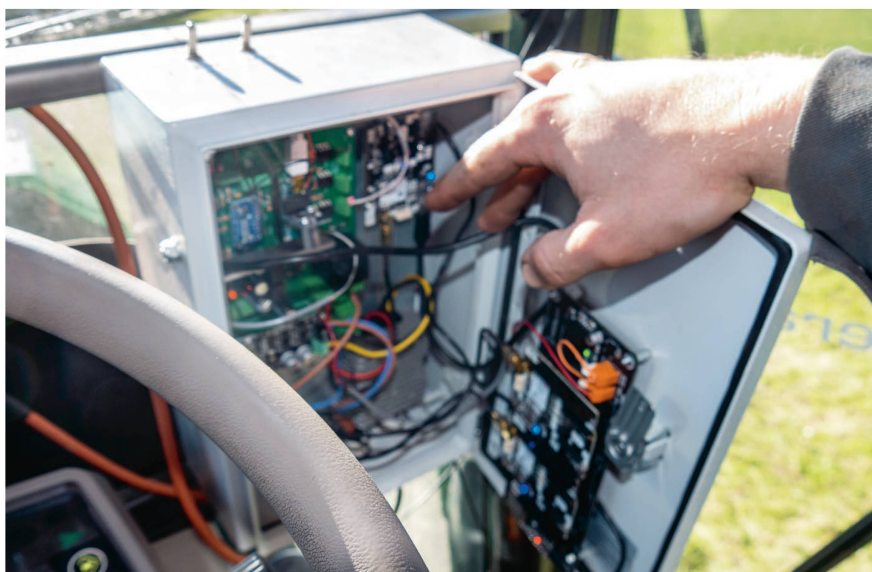
Le coffret de contrôle contenant la carte de circuit imprimé soudée par l'utilisateur, ainsi que les récepteurs GPS.
