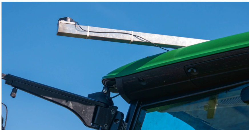
Antenne de réception des signaux du satellite et des signaux de correction RTK.
