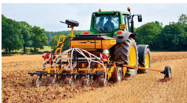
Le strip till est une méthode où le travail «passif» de la bande et le semis se font de manière distincte ou simultanée. Photo: McConnel
