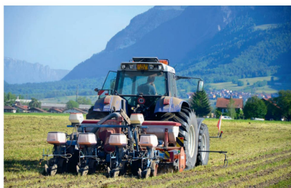
Le semis sur bandes fraisées consiste à travailler le sol en bandes avec une fraise.
