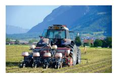
Le semis sur bandes fraisées consiste à travailler le sol en bandes avec une fraise.
