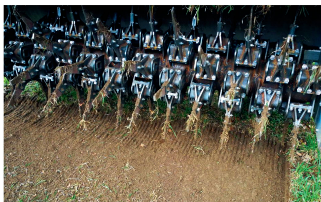
Le «BioRotor» original du Danemark (à gauche) fonctionne avec des dents en acier montées sur ressorts, tandis que la variante de l'entrepreneur Kappeler fonctionne avec des dents rigides. Photos: Ruedi Burkhalter
