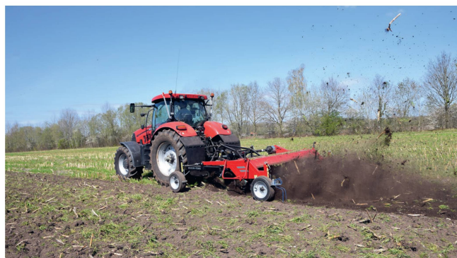
Le «Kvick Finn» fonctionne en deux phases. Le rotor intervient après l'ameublissement du sol par les socs à ailettes. Photo: G. Zevenbergen
