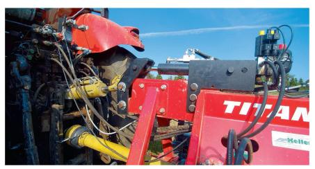
Cette fraise rabot de Massano est équipée d'un réglage automatique de la profondeur pour une précision maximale. Photo: Roman Engeler
