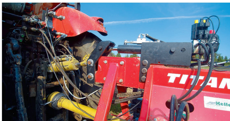
Cette fraise rabot de Massano est équipée d'un réglage automatique de la profondeur pour une précision maximale. Photo: Roman Engeler
