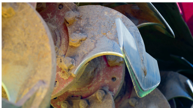
Avec le «Geohobel», la structure du sol est mieux protégée grâce à la faible vitesse de rotation des lames. Photo: Ruedi Hunger
