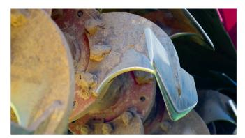
Avec le «Geohobel», la structure du sol est mieux protégée grâce à la faible vitesse de rotation des lames. Photo: Ruedi Hunger
