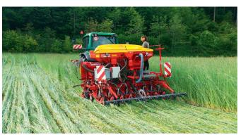
Pour les essais de sous-semis, un semoir en ligne a été transformé afin que le maïs et le semis intercalaire puissent être mis en place simultanément, en un seul passage.
