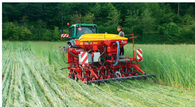
Pour les essais de sous-semis, un semoir en ligne a été transformé afin que le maïs et le semis intercalaire puissent être mis en place simultanément, en un seul passage.
