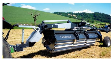
Grâce à un train roulant pivotant, le rouleau de 4,5 tonnes de Famatech peut être transporté avec des tracteurs plus légers.
