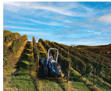
Il est «dans les tuyaux», ce tracteur viticole à chenilles propulsé au méthane.
