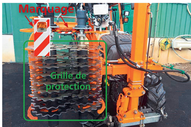
Un marquage supplémentaire, un feu clignotant et une grille de protection sont absolument nécessaires pour respecter la réglementation sur la circulation routière.
