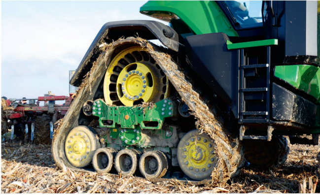
Les chenilles triangulaires font plus que doubler la surface d'empreinte au sol par rapport aux pneus.
