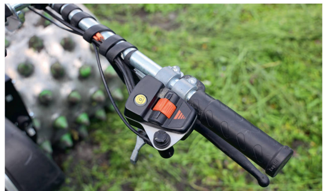
Une poignée rotative montée à la gauche du guidon sert à sélectionner le sens d'avancement, la poignée installée sur la droite détermine la vitesse de déplacement.
