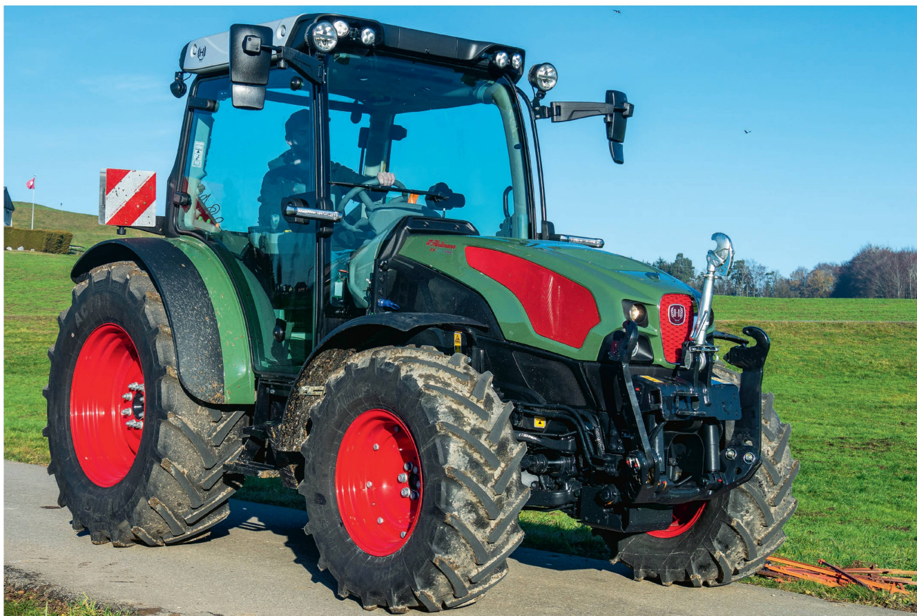
Le Hürlimann «XA 110.4 V-Drive» est un poids plume qui se distingue par une grande agilité. Il est équipé d'un moteur 4-cylindres répondant à la norme anti-pollution 3b. Photos: Roman Engeler
