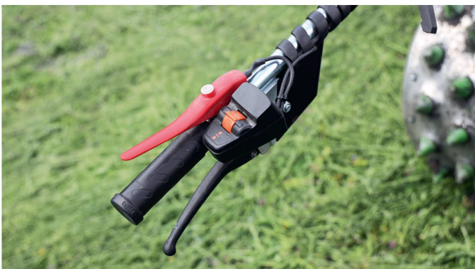
Une poignée rotative montée à la gauche du guidon sert à sélectionner le sens d'avancement, la poignée installée sur la droite détermine la vitesse de déplacement.
