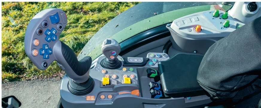
Quatre boutons peuvent être affectés librement, ce qui permet de personnaliser l'accoudoir de commande et le joystick.
