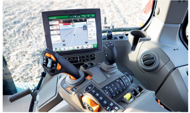
La commande avec afficheur des tracteurs à chenilles de la série «8RX» est analogue à celle des modèles à pneus.
