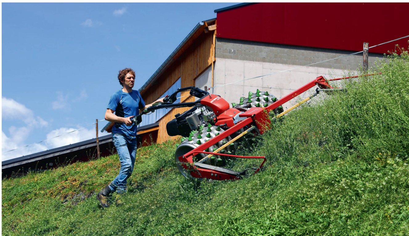
La commande «DualDrive» de la faucheuse «Motech» de Reform rend la conduite moins fatigante qu'avec les systèmes par poignées rotatives.
