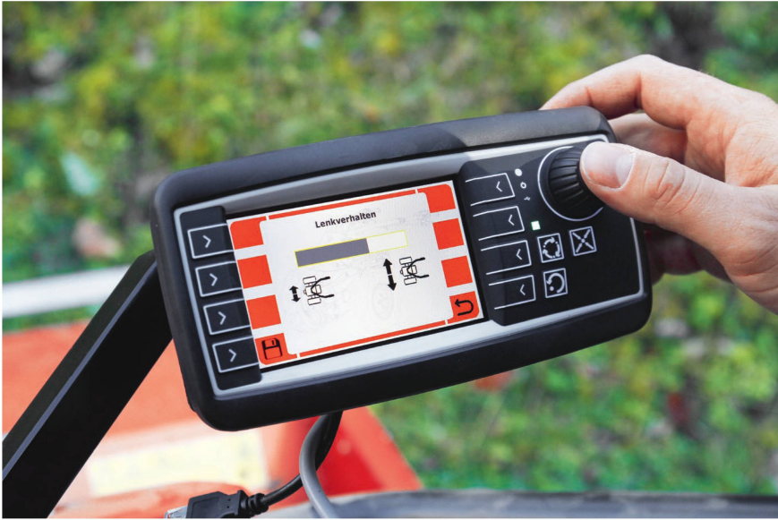
Ce module de diagnostic permet d'adapter la commande de la motofaucheuse aux besoins du conducteur.
