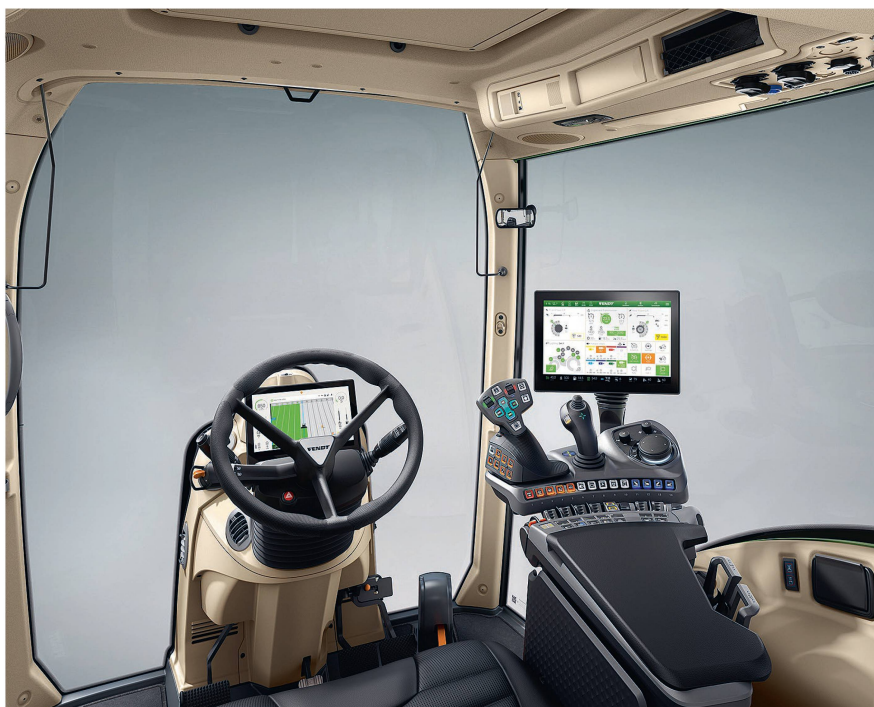
La commande du tracteur s'inspire de plus en plus des tablettes et des smartphones. Elle intègre notamment la technologie haptique. Photo: Fendt
