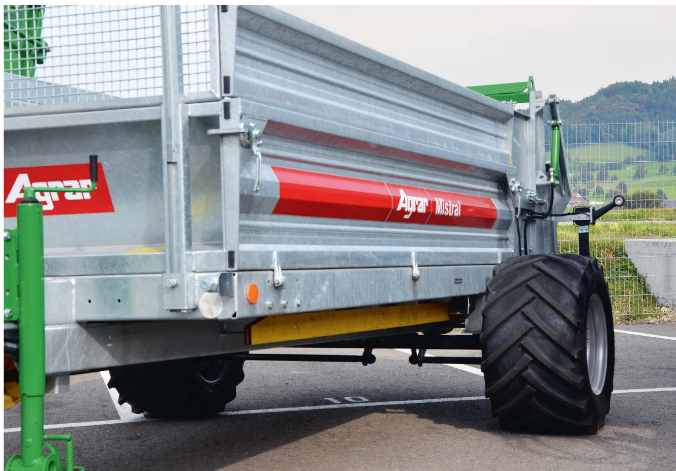
L'épandeur de montagne classique est installé sur un essieu surbaissé et possède un hérissos vertical. Photo: Ruedi Hunger
