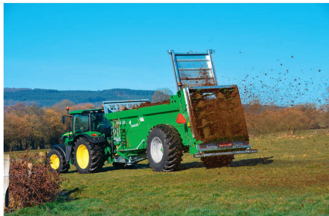
Épandeur à caisse étroite surbaissé avec de grandes roues et deux rouleaux d'épandage de grand diamètre. Photo: Joskin
