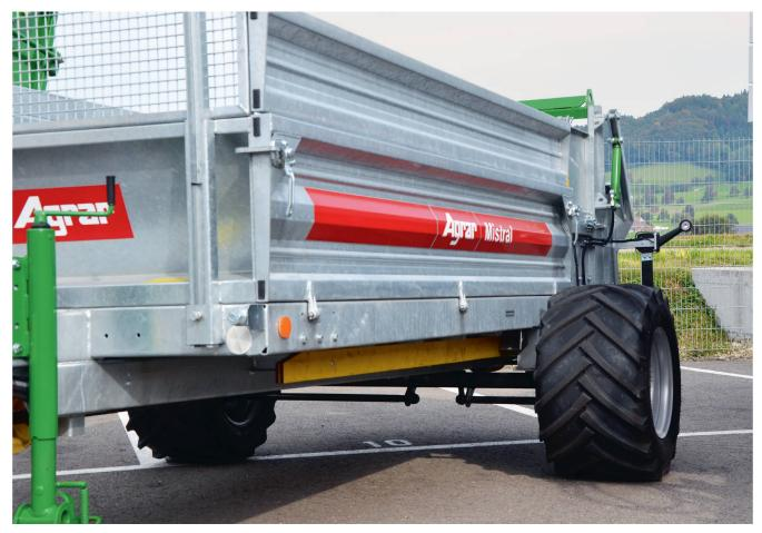
L'épandeur de montagne classique est installé sur un essieu surbaissé et possède un hérisson vertical. Photo: Ruedi Hunger
