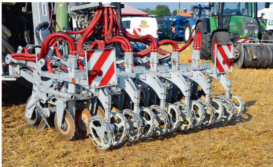
Solution ultime: l'incorporation immédiate du lisier évite les émissions d'ammoniac.
