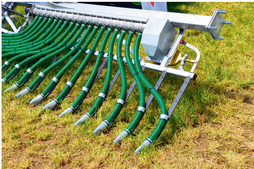
Les patins marquent le sol ou le couvert végétal juste assez pour permettre l'écoulement rapide du lisier.
