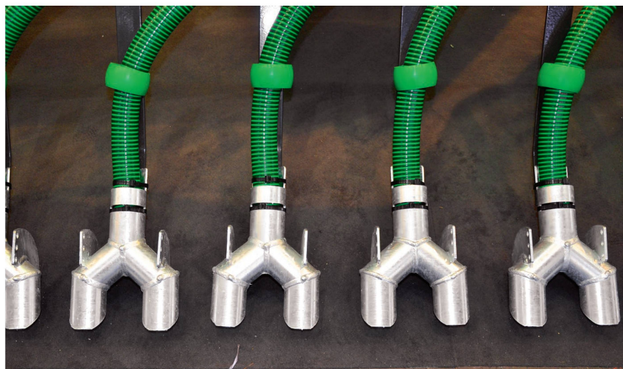
La tendance actuelle vise à diviser le flux de lisier à la sortie du tuyau.
