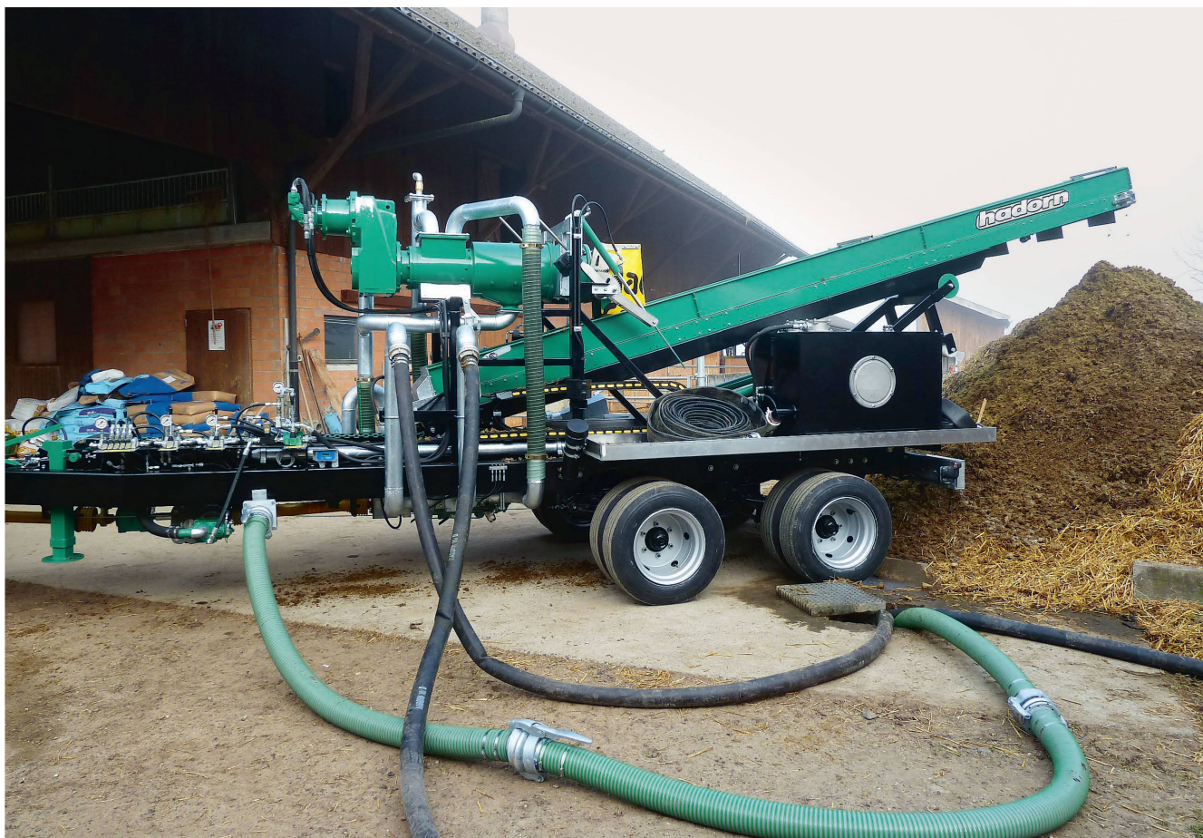
On utilise principalement des compacteurs à vis pour la séparation des lisiers bovins et des digestats. Les séparateurs mobiles (photo) sont souvent proposés par les entrepreneurs de travaux agricoles ou les cercles de machines. Photo: Hadorn
