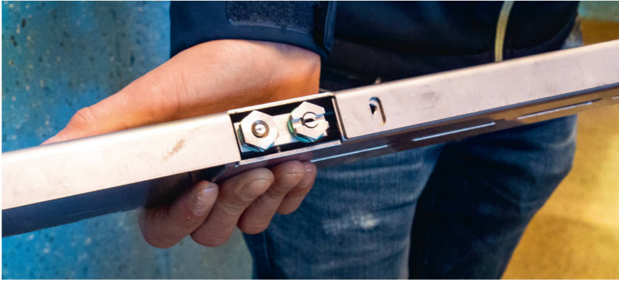
Le système qui se compose des buses de lavage (gauche) et de désinfection (droite) est inséré dans ce rail en acier inoxydable.
