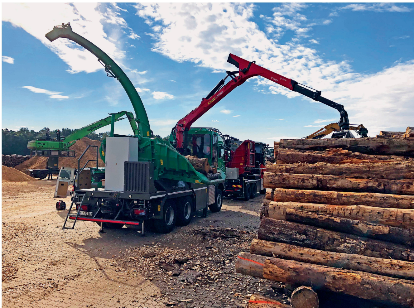
Le test final a démontré que l'entraînement hybride permet d'économiser 20% de diesel dans une déchiqueteuse à bois par rapport à un modèle conventionnel. Photos: Heike Fischer, université technique de Cologne (D)
