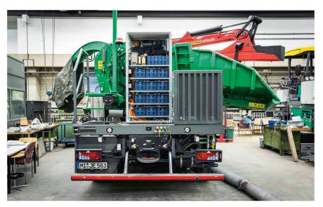
L'énergie excédentaire est stockée dans treize supercondensateurs (au centre); elle peut être réutilisée en mode «boost».
