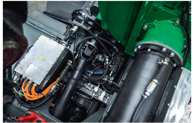
L'entraînement hybride (à gauche) assiste la déchiqueteuse lorsque la puissance nécessaire dépasse celle du moteur à combustion au point de fonctionnement optimal.
