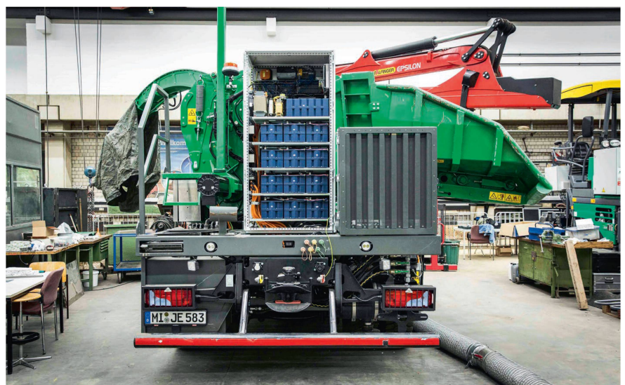
L'énergie excédentaire est stockée dans treize supercondensateurs (au centre); elle peut être réutilisée en mode «boost».
