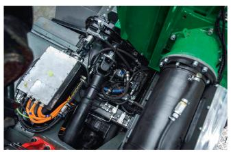
L'entraînement hybride (à gauche) assiste la déchiqueteuse lorsque la puissance nécessaire dépasse celle du moteur à combustion au point de fonctionnement optimal.
