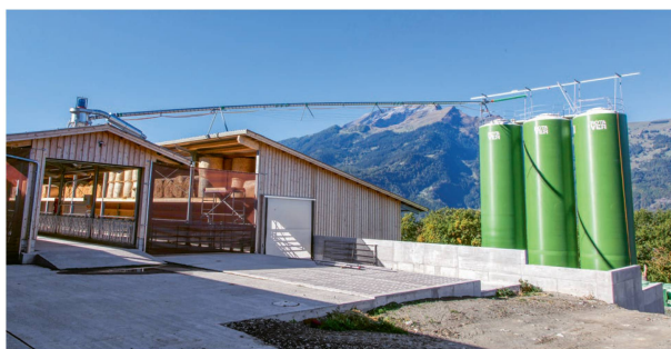
Ce système Stocker de transport par conduites est doté d'un turbo-cyclone fonctionnant de façon très silencieuse grâce à un amortisseur de bruit.
