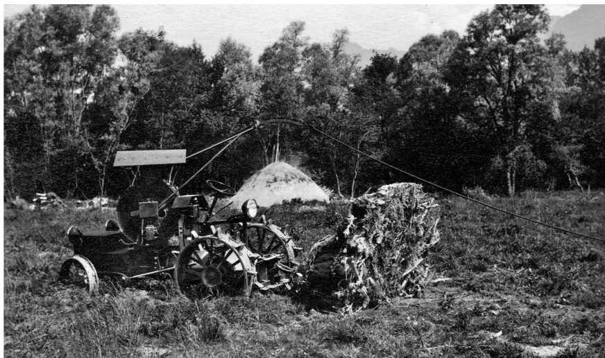
Le tracteur électrique Vevey tire une souche lors de travaux d'essartage; le tambour peut contenir 400 mètres de câble électrique.
