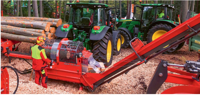
Avec les scies-fendeuses combinées, les troncs sont débités et les bûches préparées à la longueur voulue.
