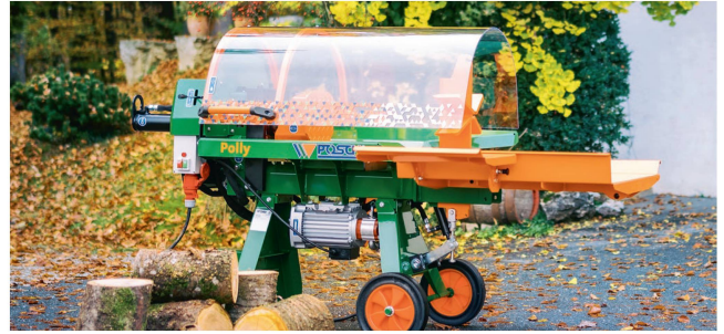
La sécurité, une priorité: les leviers ne doivent pouvoir être actionnés d'une seule main.
