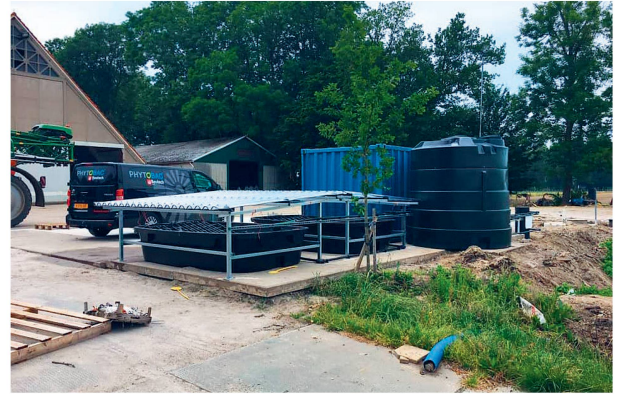
Les systèmes de traitement biologique, tels «Biobed», «Biopac» (en photo), utilisent l'évaporation de l'eau et la dégradation des résidus de phytos par des microorganismes. Photo: Biopac
