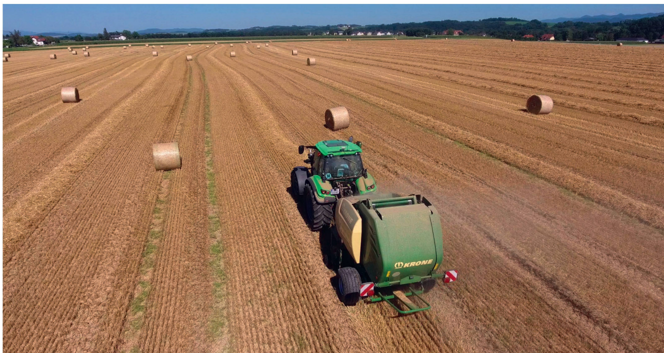
Un système «TIM» ( tractor implement management ) agit sur les processus de travail du tracteur. Pendant le pressage, le tracteur est arrêté et l'ouverture de la porte ainsi que l'action de l'éjecteur de balles sont commandés par la presse. Photos et schémas: Innovation Farm
