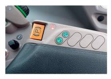
Le bouton d'activation de la commande «TIM» est installé sur l'accoudoir du tracteur.
