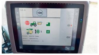
Sur la photo de gauche, on voit le statut actuel de la liaison entre le tracteur et la presse à balles rondes. Les différentes interventions de la presse ne doivent être confirmées qu'une seule fois par le conducteur. La photo de droite représente l'affichage de la fonction «TIM» sur l'écran du terminal du tracteur.
