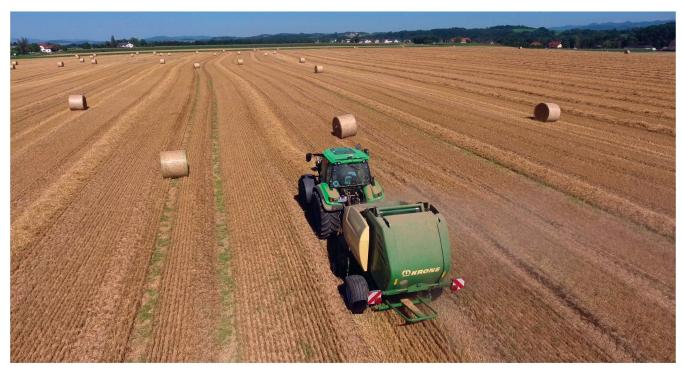
Un système «TIM» (tractor implement management) agit sur les processus de travail du tracteur. Pendant le pressage, le tracteur est arrêté et l'ouverture de la porte ainsi que l'action de l'éjecteur de balles sont commandés par la presse. Photos et schémas: Innovation Farm
