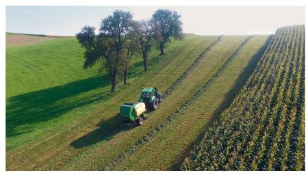
Dans la pente, la dépose de la balle se réalise comme de coutume au sommet d'une butte ou en orientant la presse pour que l'arrière regarde légèrement vers le haut.
