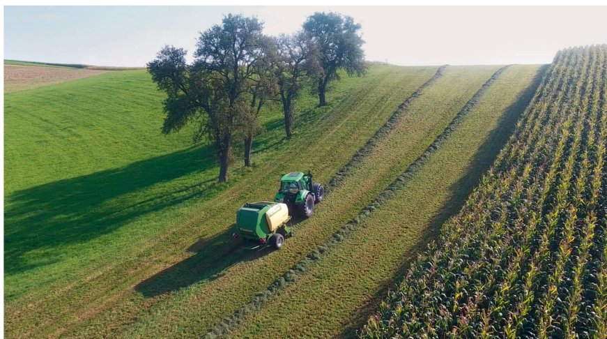
Dans la pente, la dépose de la balle se réalise comme de coutume au sommet d'une butte ou en orientant la presse pour que l'arrière regarde légèrement vers le haut.
