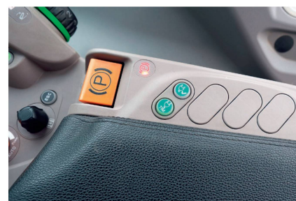
Le bouton d'activation de la commande «TIM» est installé sur l'accoudoir du tracteur.
