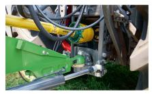
La remorque s'attelle en bas du tracteur auquel la relient aussi deux tringles de direction forcée à vérins hydrauliques.
