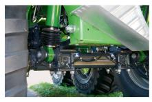
Le train roulant tridem et son correcteur de dévers hydraulique. L'essieu avant est relevable.
