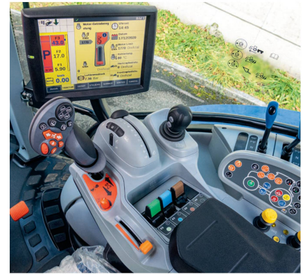
L'accoudoir «Sidewinder II» s'ajuste électriquement. Il regroupe l'écran et, à portée de main, les commandes de la transmission et de l'hydraulique.
