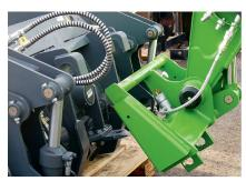
L'accouplement d'outils se fait au moyen des raccords «ZM-1» avec verrouillage hydraulique intégré.
