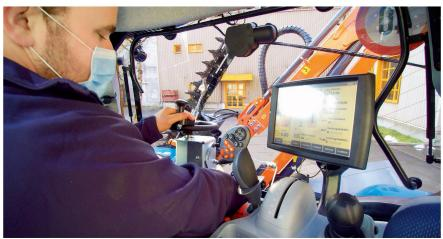
Un équipement spécial: le siège pivotant et le poste de conduite réversible.
