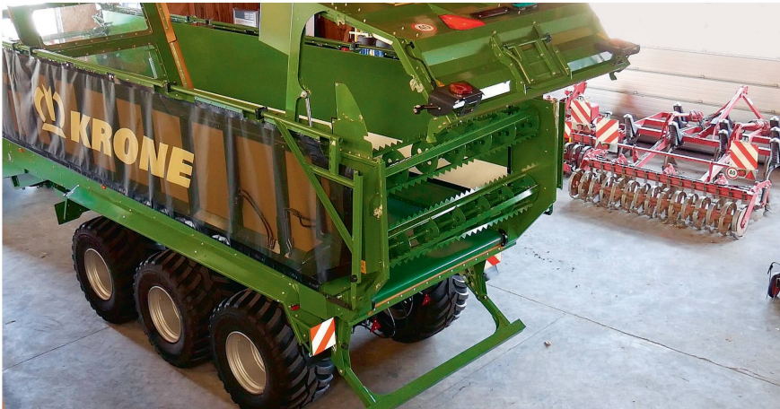
La remorque à tapis roulant avec son hayon ouvert, ses deux rouleaux doseurs et son fond poussant qui se déplace vers l'arrière. Ce dernier peut être déplacé jusqu'à l'extrémité de la surface de chargement.
