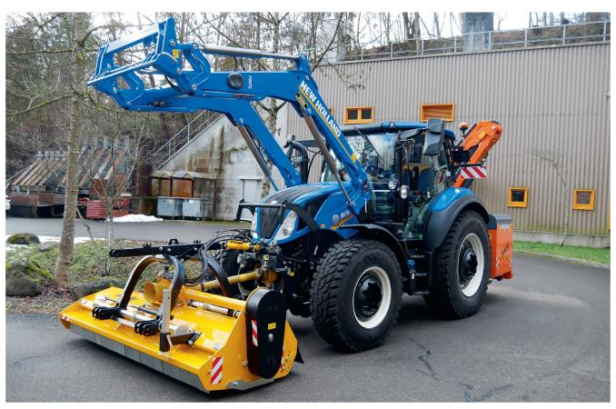
Le New Holland «T5.130 AC» tout équipé avec chargeur frontal, broyeur et épareuse à l'arrière. Photos: Heinz Röthlisberger et Roman Engeler
