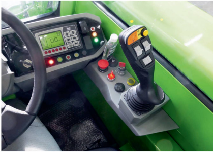
Vue dans la cabine sur l'affichage des instruments et sur le joystick capacitif.
