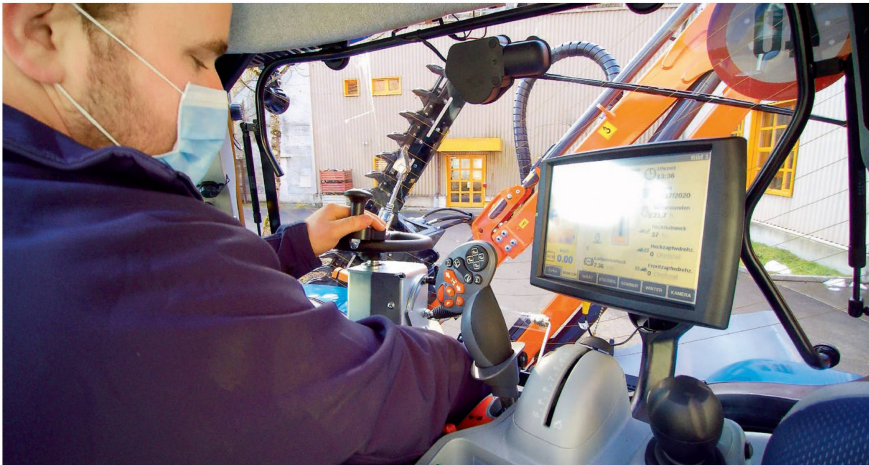
Un équipement spécial: le siège pivotant et le poste de conduite réversible.
