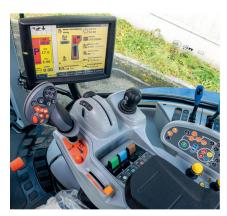
L'accoudoir «Sidewinder II» s'ajuste électriquement. Il regroupe l'écran et, à portée de main, les commandes de la transmission et de l'hydraulique.
