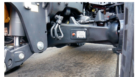
La suspension avant «Terraglide» peut être réglée manuellement.
