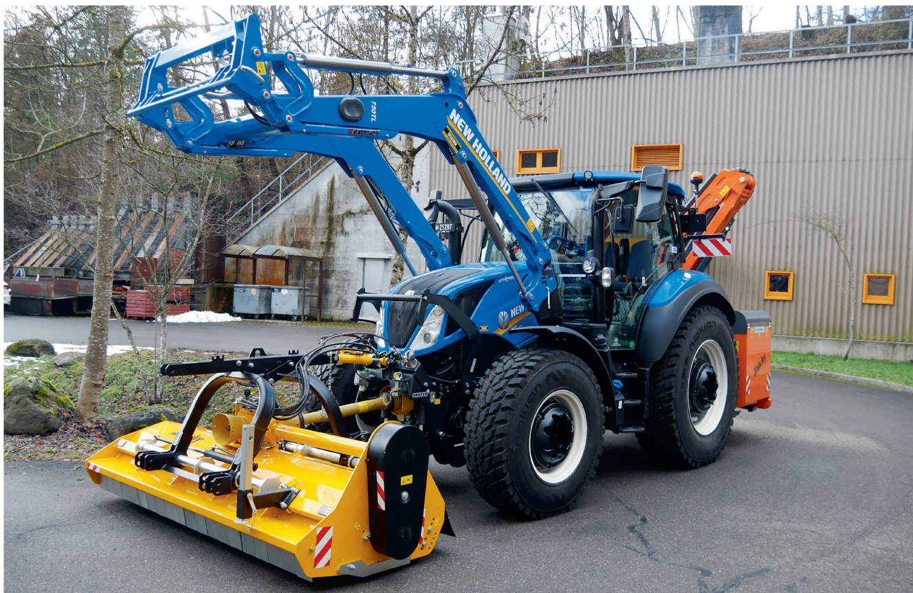
Le New Holland «T5.130 AC» tout équipé avec chargeur frontal, broyeur et épareuse à l'arrière. Photos: Heinz Röthlisberger et Roman Engeler
