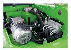
Un des trois moteurs électriques installés sur le «e-Worker 24.5-90 4WD» assure l'entraînement de l'hydraulique.
