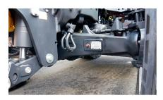
La suspension avant «Terraglide» peut être réglée manuellement.
