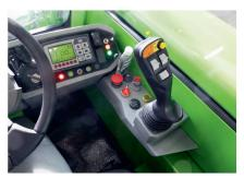
Vue dans la cabine sur l'affichage des instruments et sur le joystick capacitif.
