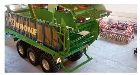
La remorque à tapis roulant avec son hayon ouvert, ses deux rouleaux doseurs et son fond poussant qui se déplace vers l'arrière. Ce dernier peut être déplacé jusqu'à l'extrémité de la surface de chargement.
