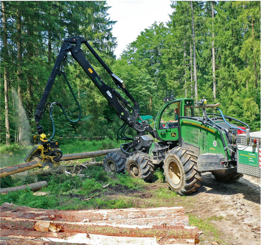
Dispositif de mesure des émissions monté à l'arrière d'une moissonneuse-batteuse. Photo: TFZ
