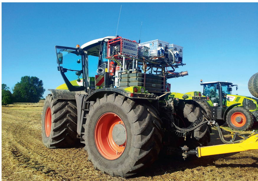
Les mesures d'émissions en conditions d'utilisation réelles mettent la vérité à jour. Photo: TFZ
