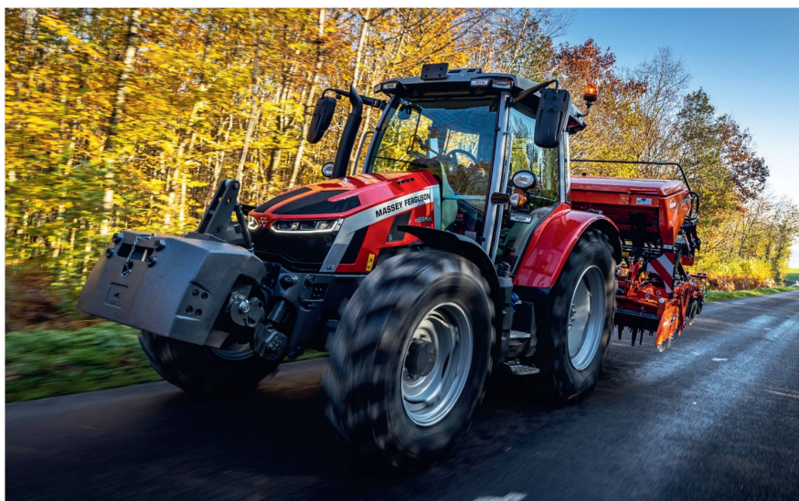
Leur capacité de relevage arrière constante de 5700 kg et leur poids total autorisé de 9,5 tonnes autorisent les «MF 5S» à emporter de lourds outils. Photo: MF
