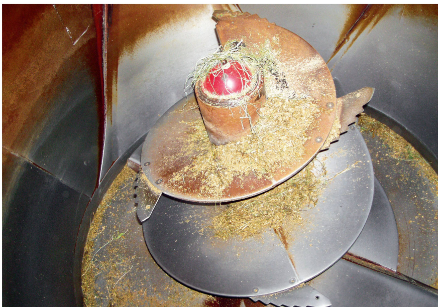
Les couteaux d'une vis mélangeuse sont soumis à une usure continue qui augmente la consommation de carburant. Photos: Ruedi Hunger
