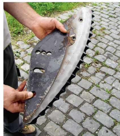
Les couteaux doivent être vérifiés lorsque la durée du mélange se prolonge.
