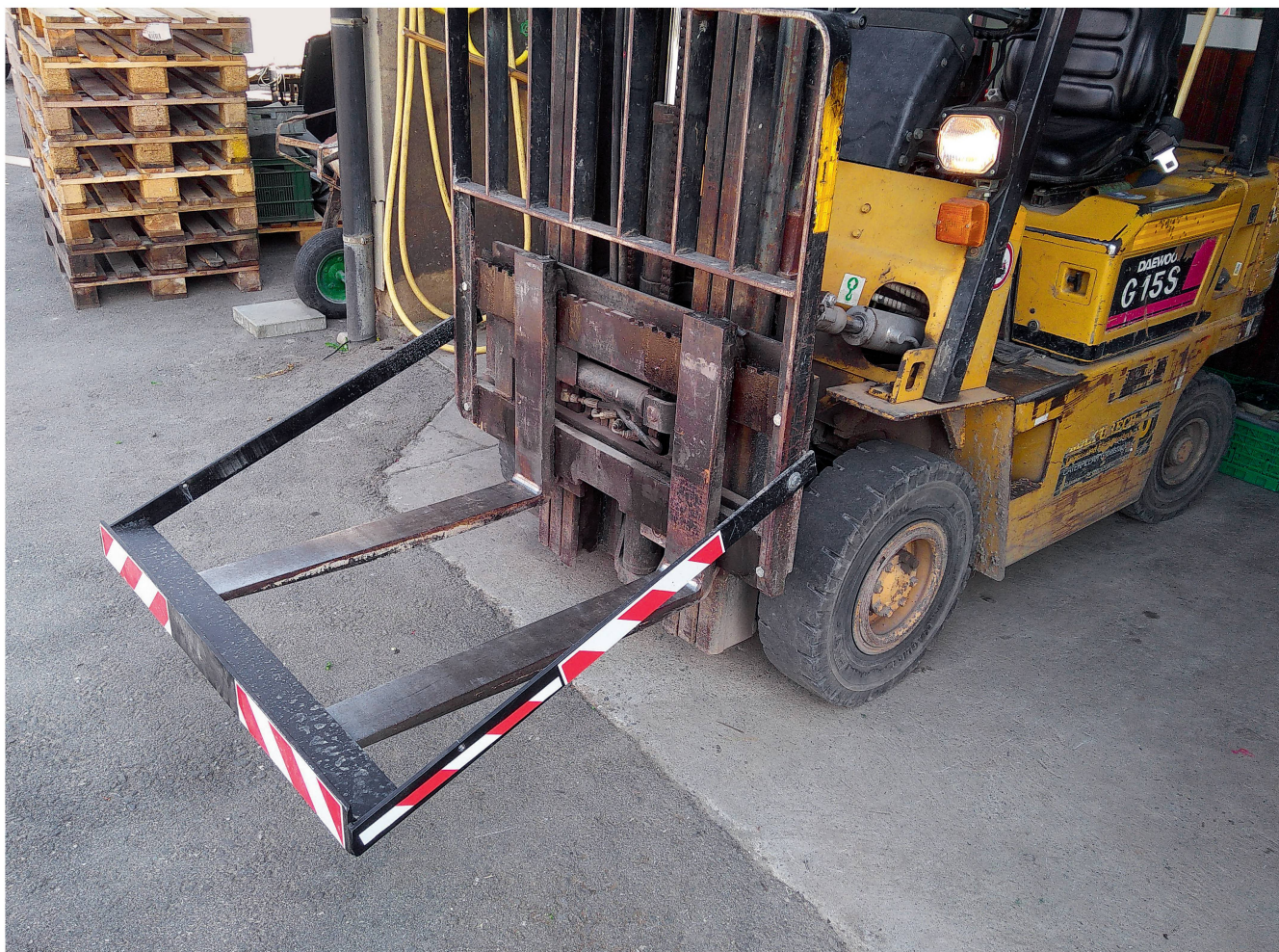
Une solution pour sécuriser les fourches d'un chariot élévateur. Cet étrier se rabat sur les fourches. Une fois remonté, il est maintenu en position haute par deux petits arrêtoirs. Photo: M. Etter
