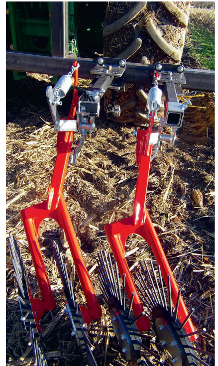
Les outils rotatifs en forme d'étoile saisissent les chaumes qui jonchent le sol après la récolte et les redressent pour que la machine puisse mieux les broyer.
