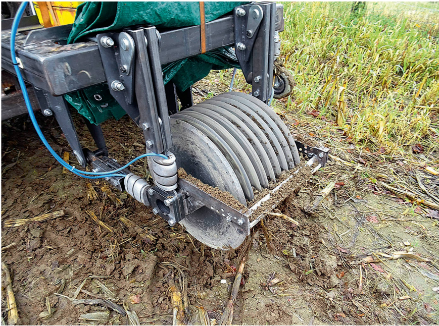
Des disques verticaux acérés coupent et réduisent les racines en petits morceaux. Cette opération s'effectue après leur passage dans le broyeur. Photos: TH Köln
