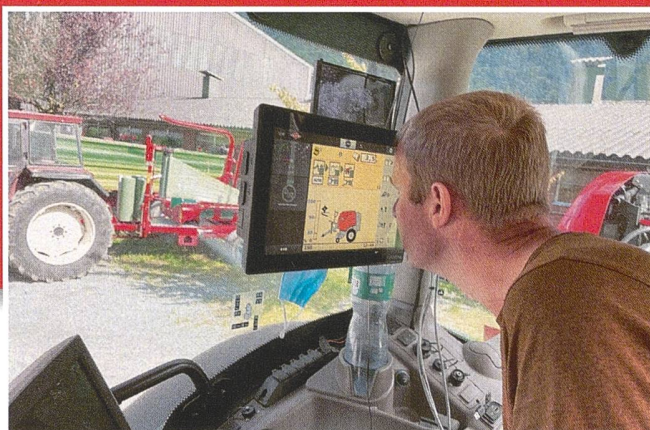
Le terminal à écran tactile «CC1200» permet à «Wisi» Zraggen de piloter la presse à balles du bout du nez.
