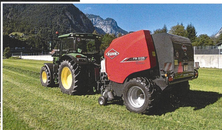
La machine, avec rotor d'alimentation intégré et système de liage par film «Twin-Reel». Très efficace pour l'ensilage aussi!
