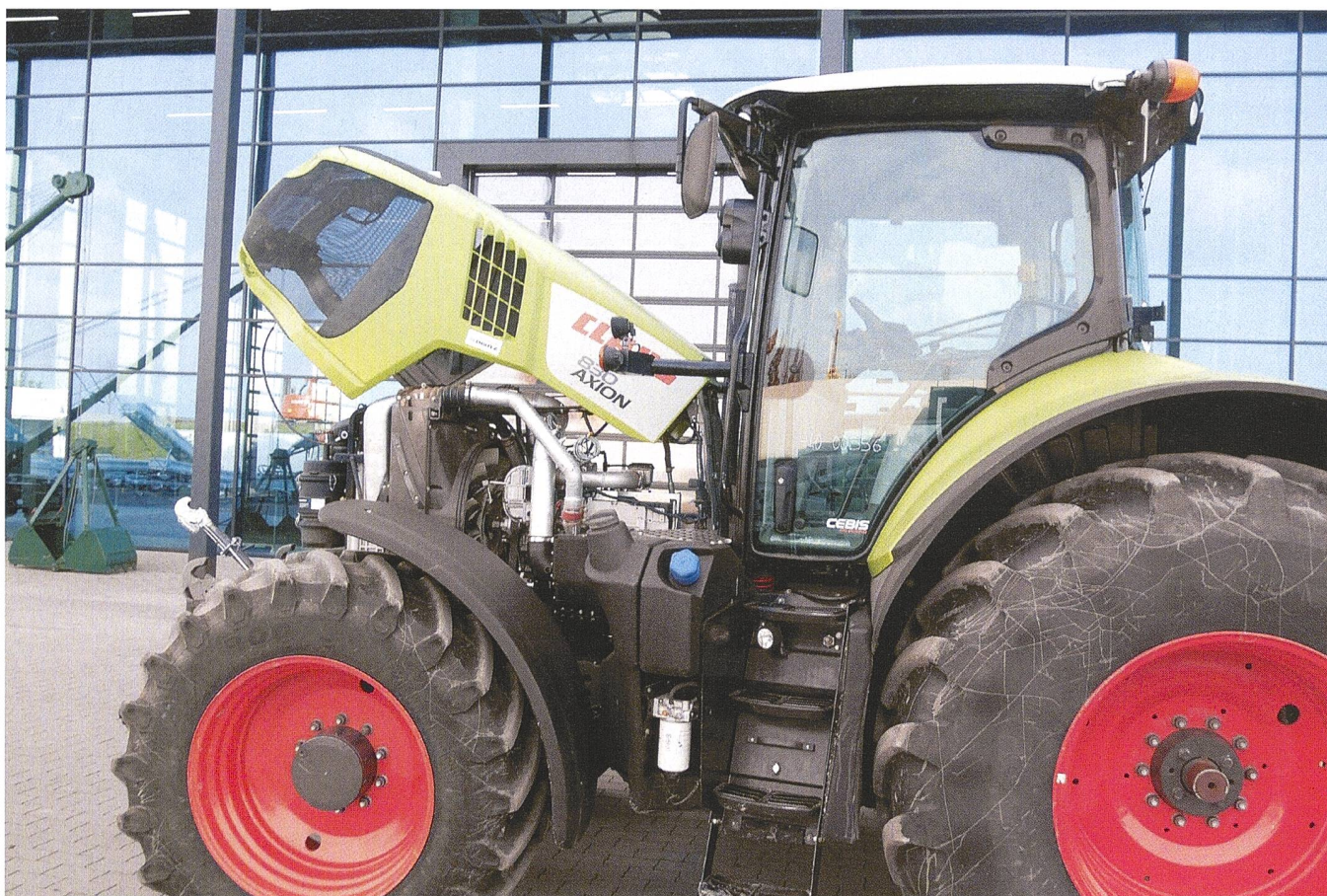
«Downsizing» d'un moteur de six à quatre cylindres. Malgré la réduction de cylindrée, le Claas «Axion 830» offre les mêmes performances, voire, en cas d'assistance électrique, de meilleures valeurs de couple et davantage de place sous le capot. Photos: Heinz Röthlisberger
