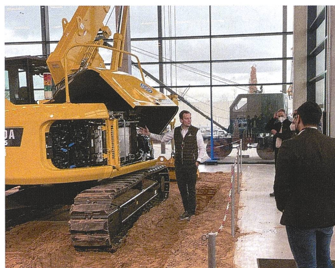
En collaboration avec le japonais Maeda, Deutz a mis au point une grue sur chenilles entièrement électrique de 40 kW, offrant une capacité de levage de six tonnes. Photo: Deutz
