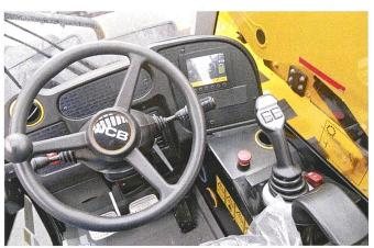
Le chariot télescopique électrique JCB adopte de nouveaux tableau de bord et afficheur. Le système breveté «Adaptive Load Control» contrôlant l'équilibre des charges est également incorporé.
