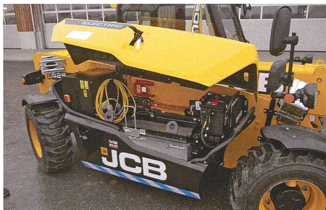
La batterie de 96 volts au lithium-ion possède une capacité de 24 kWh. Elle est chargée par une alimentation standard ou par un chargeur rapide disponible en option.
