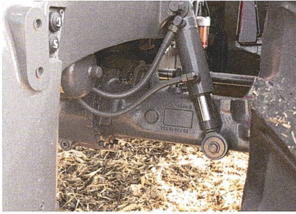
L'essieu avant et sa suspension à 140 mm de débattement fait partie de l'équipement de base du «MF 7S.190».
