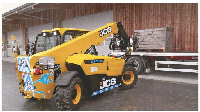
Travailler à la ferme sans gaz d'échappement: le chargeur télescopique électrique «525-60E» de JCB, muni d'une batterie de 96 V au lithiumion, possède deux moteurs électriques distincts. Photos: Heinz Röthlisberger
