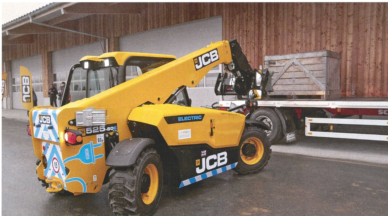
Travailler à la ferme sans gaz d'échappement: le chargeur télescopique électrique «525-60E» de JCB, muni d'une batterie de 96 V au lithium-ion, possède deux moteurs électriques distincts. Photos: Heinz Röthlisberger
