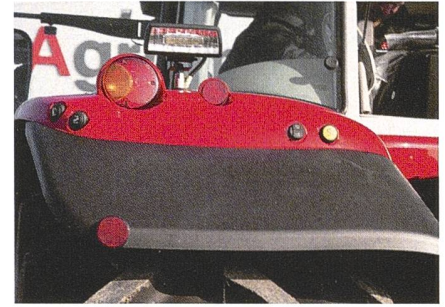
Boutons de commandes extérieures du relevage, du distributeur et de la prise de force, avec sélection du régime moteur.
