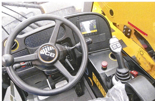
Le chariot télescopique électrique JCB adopte de nouveaux tableau de bord et afficheur. Le système breveté «Adaptive Load Control» contrôlant l'équilibre des charges est également incorporé.
