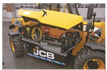
La batterie de 96 volts au lithium-ion possède une capacité de 24 kW/h. Elle est chargée par une alimentation standard ou par un chargeur rapide disponible en option.
