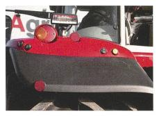
Boutons de commandes extérieures du relevage, du distributeur et de la prise de force, avec sélection du régime moteur.
