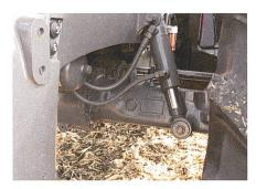
L'essieu avant et sa suspension à 140 mm de débattement fait partie de l'équipement de base du «MF 75.190».
