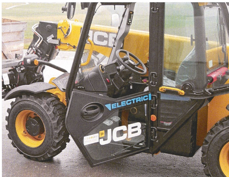
La cabine au vitrage intégral dispose d'un chauffage de 2,2 kW et de vitres frontales, arrière et latérales chauffées.
