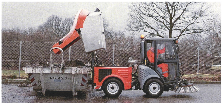
Les véhicules articulés se prêtent bien au montage de systèmes d'aspiration et de balayage compacts. Photo: Hako
