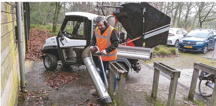
Ce véhicule simple est muni d'un sac de collecte, d'un flexible et d'une buse d'aspiration manuelle. Photo: ldd
