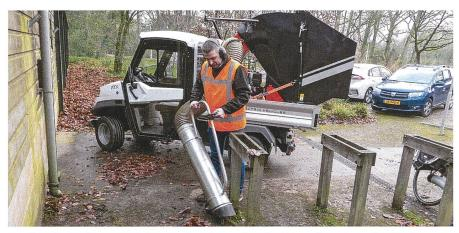
Ce véhicule simple est muni d'un sac de collecte, d'un flexible et d'une buse d'aspiration manuelle.  $\,^{\text{Photo: Idd}}$
