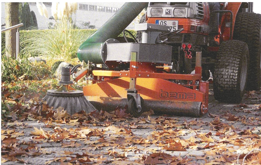
Une unité de balayage et d'aspiration équipée d'une turbine avec broyeur ramasse les feuilles mortes efficacement et proprement. Photo: Bema
