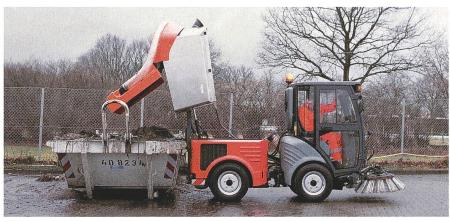
Les véhicules articulés se prêtent bien au montage de systèmes d'aspiration et de balayage compacts. Photo: Hako
