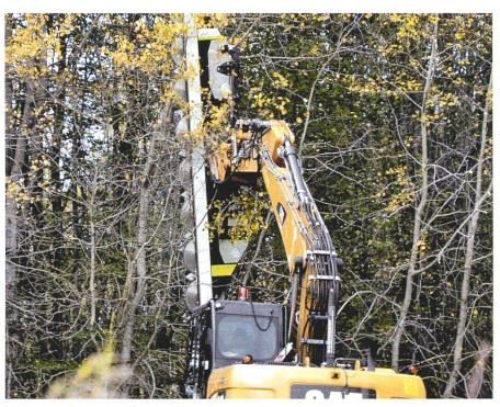
Les lamiers d'élagage présentant plus de quatre lames circulaires nécessitent un véhicule porteur adapté garantissant la stabilité. Photo: Idd
