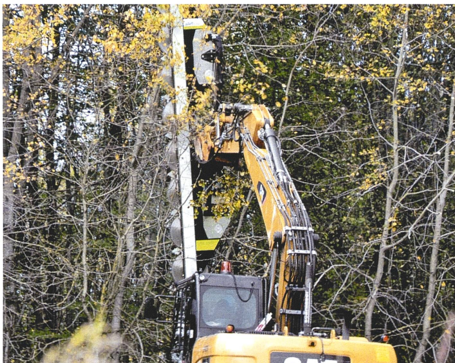
Les lamiers d'égaleage présentant plus de quatre lames circulaires nécessitent un véhicule porteur adapté garantissant la stabilité. Photo: ldd
