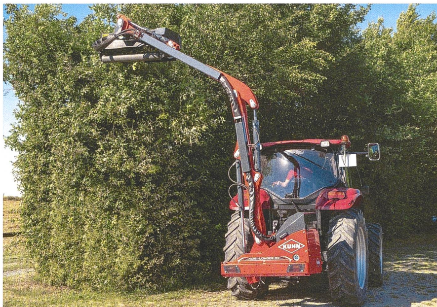
Une épareuse avec tête de broyage ne fournit pas de travail sélectif, mais ne requiert pas de seconde intervention pour ramasser les branches. Photo: Kuhn
