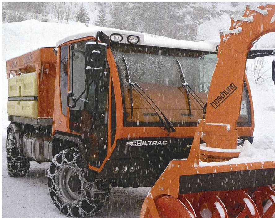
Saleuse à saumure sur le pont, fraise à neige sur le front : voilà comment tirer profit d'un véhicule de transport agricole en hiver.
