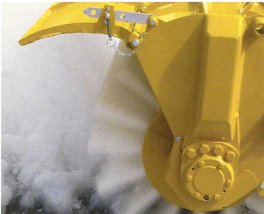
Il n'y a pas toujours besoin d'un chasse-neige. La neige poudreuse peut être simplement balayée à la brosse rotative.
