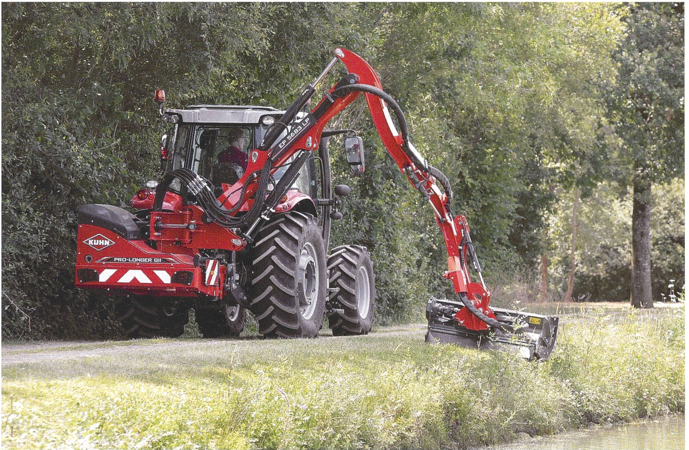
Un tracteur standard suffit à entraîner une épareuse à bras articulé. Photo: Kuhn
