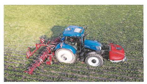
Désormais, l'«EC-Weeder» est aussi disponible en combinaison avec une cuve frontale pour former une solution compacte de pulvérisation en bandes.
