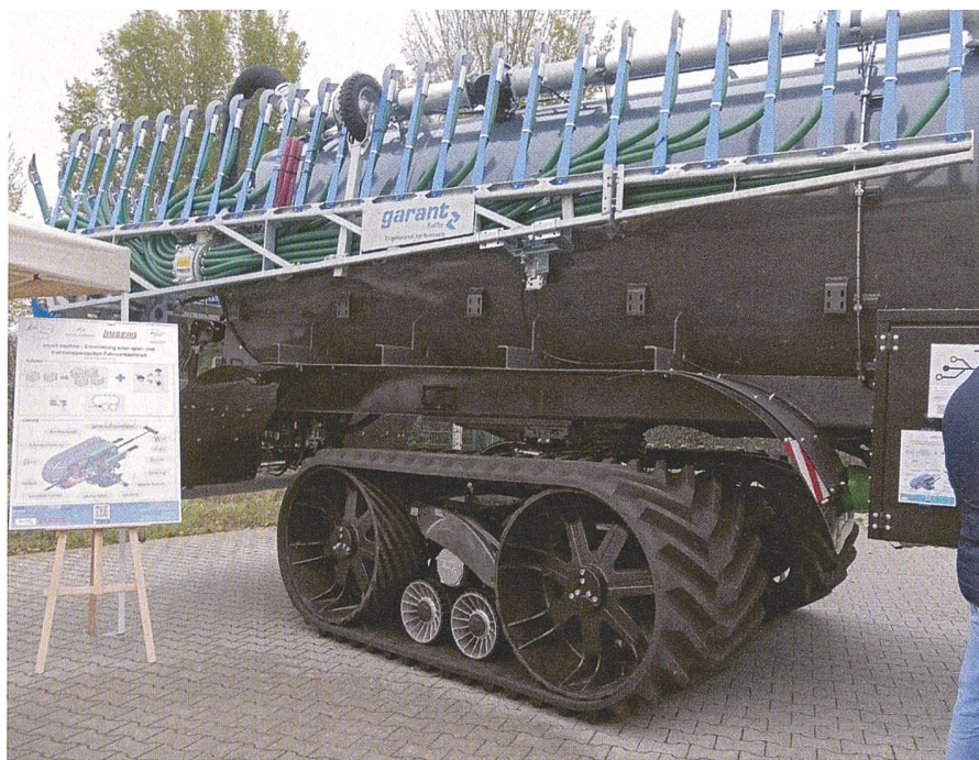
Les chenilles sont plutôt rares sur les citernes à lisier; des solutions spécifiques pour l'application du lisier font actuellement l'objet de recherches, notamment de Kotte en collaboration avec l'université d'Osnabrück. Photo: Roman Engeler
