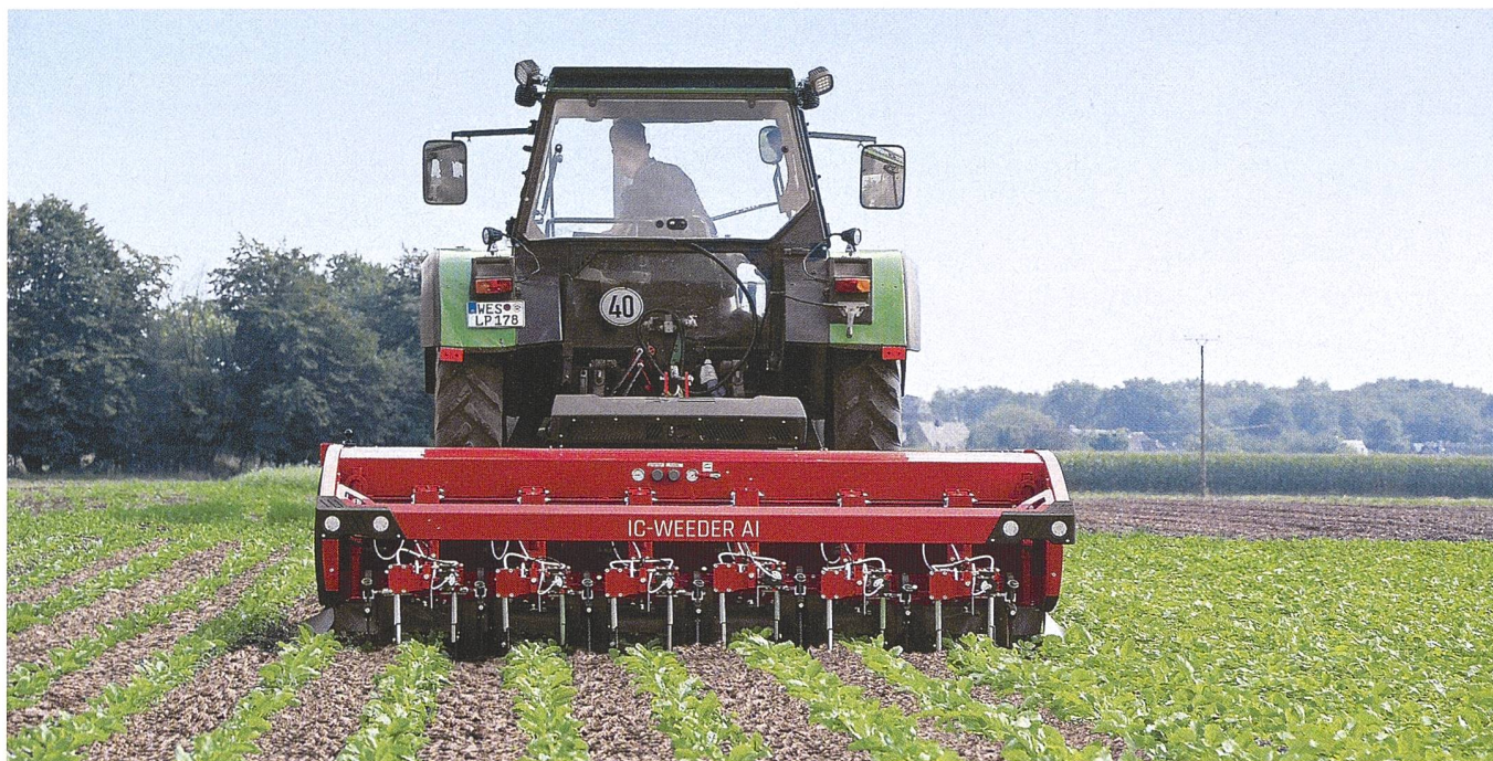
Le désherbage mécanique gagne en efficacité lorsque les machines, tel ce «IC-Weeder» de Steketee, différencient d'elles-mêmes les plantes cultivées des adventices grâce à l'intelligence artificielle, et peuvent travailler en conséquence de façon ciblée. Photos: Lemken
