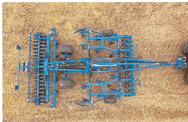
Sur le déchaumeur à trois rangées de dents «Karat 10», les pièces travaillantes sont désormais réparties de façon symétrique par rapport à l'axe de traction. L'outil est ainsi plus facile à tirer.
