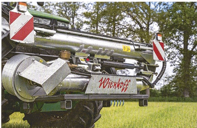
Caractéristique unique de Wienhoff: la trompe d'aspiration «Free-sight», repliable transversalement et brevetée. Photo: Wienhoff
