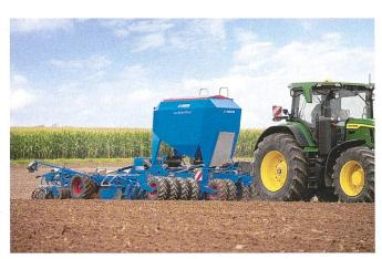
Une nouvelle machine avec travail du sol réorganisé (comprenant des roues de rappui) et technologie de semis éprouvée: le «Solitair DT» avec double trémie et largeurs de travail de 4 et 6 m.
