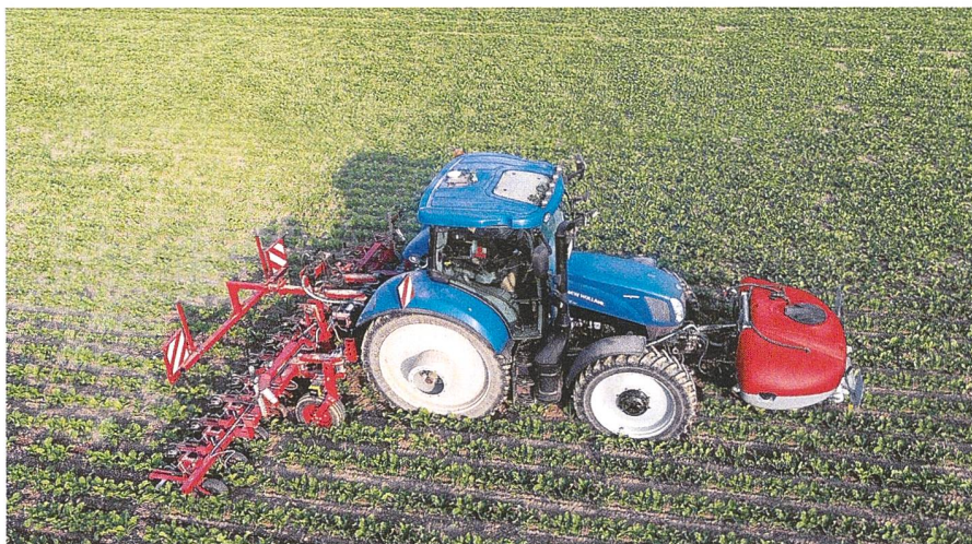
Désormais, l'«EC-Weeder» est aussi disponible en combinaison avec une cuve frontale pour former une solution compacte de pulvérisation en bandes.
