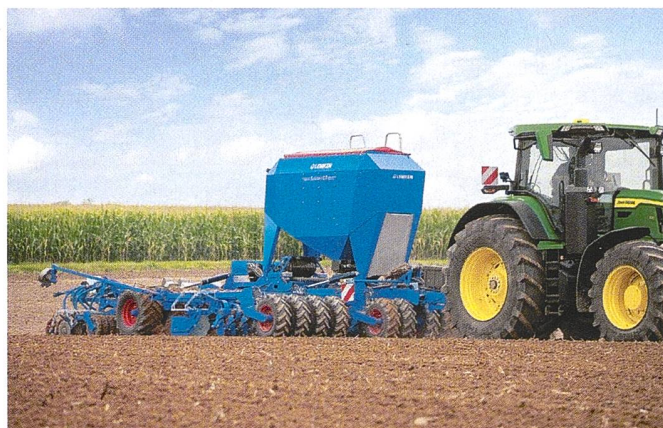
Une nouvelle machine avec travail du sol réorganisé (comprenant des roues de rappui) et technologie de semis éprouvée: le «Solitaire DT» avec double trémie et largeurs de travail de 4 et 6 m.
