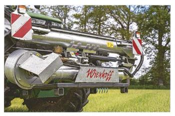
Caractéristique unique de Wienhoff: la trompe d'aspiration «Freesight», repliable transversalement et brevetée. Photo: Wienhoff
