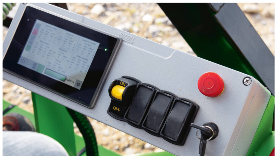
Vue du pupitre de commande avec son afficheur et les boutons d'activation de la barre de coupe (jaune) et de l'éclairage.
