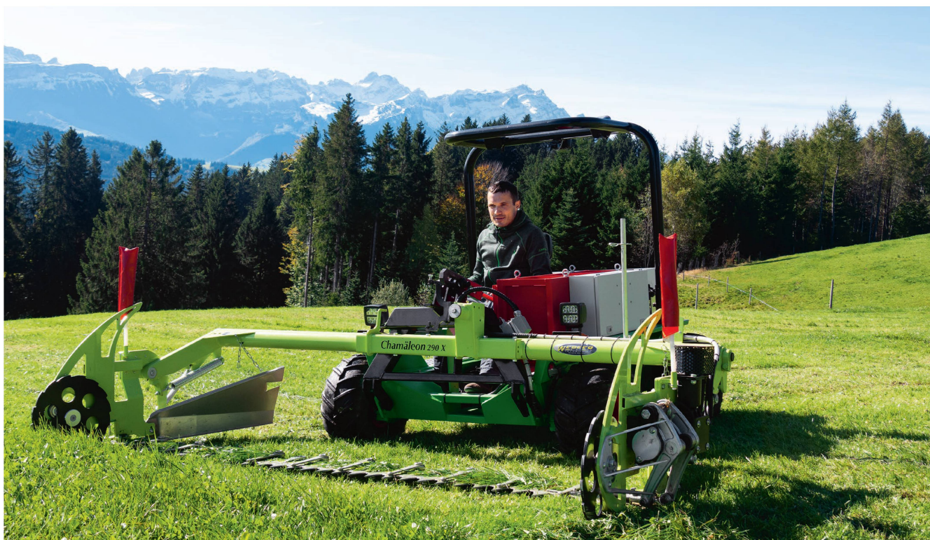
Heinz Bodenmann avec son «e-Berg-Trak 802» et le dispositif de fauche «Chamäleon 290» en plein travail. Photos: Roman Engeler
