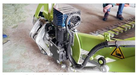
C'est ce moteur électrique qui entraîne la faucheuse.
