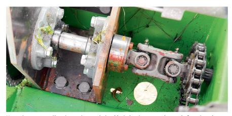
L'entraînement est électrique, via une chaîne (droite) qui transmet le couple fourni par le moteur aux deux roues correspondantes de part et d'autre du véhicule. L'articulation à cardan double est également visible.
