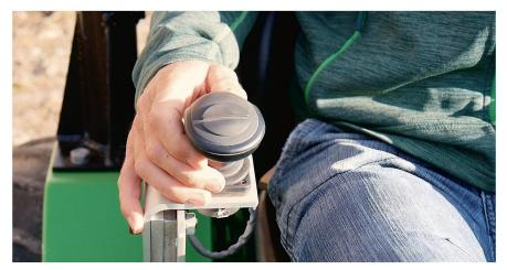
Le joystick intégré dans l'accoudoir droit peut être déplacé selon trois axes. Il commande l'accélération et la direction du véhicule.
