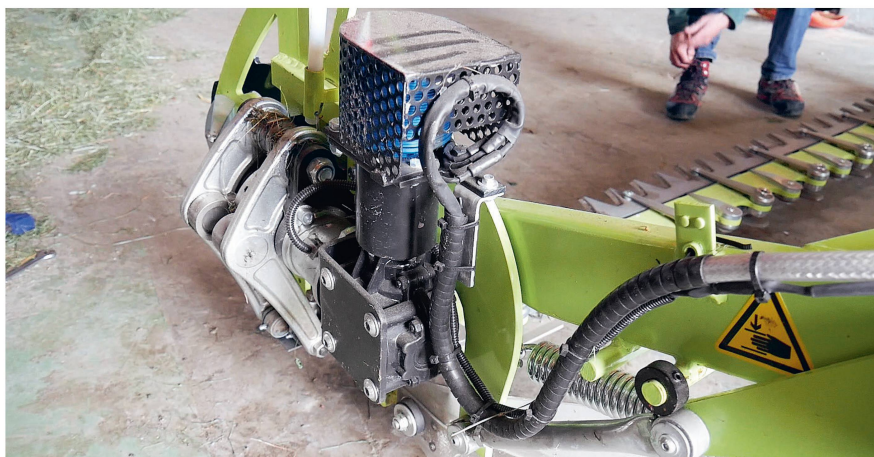
C'est ce moteur électrique qui entraîne la faucheuse.
