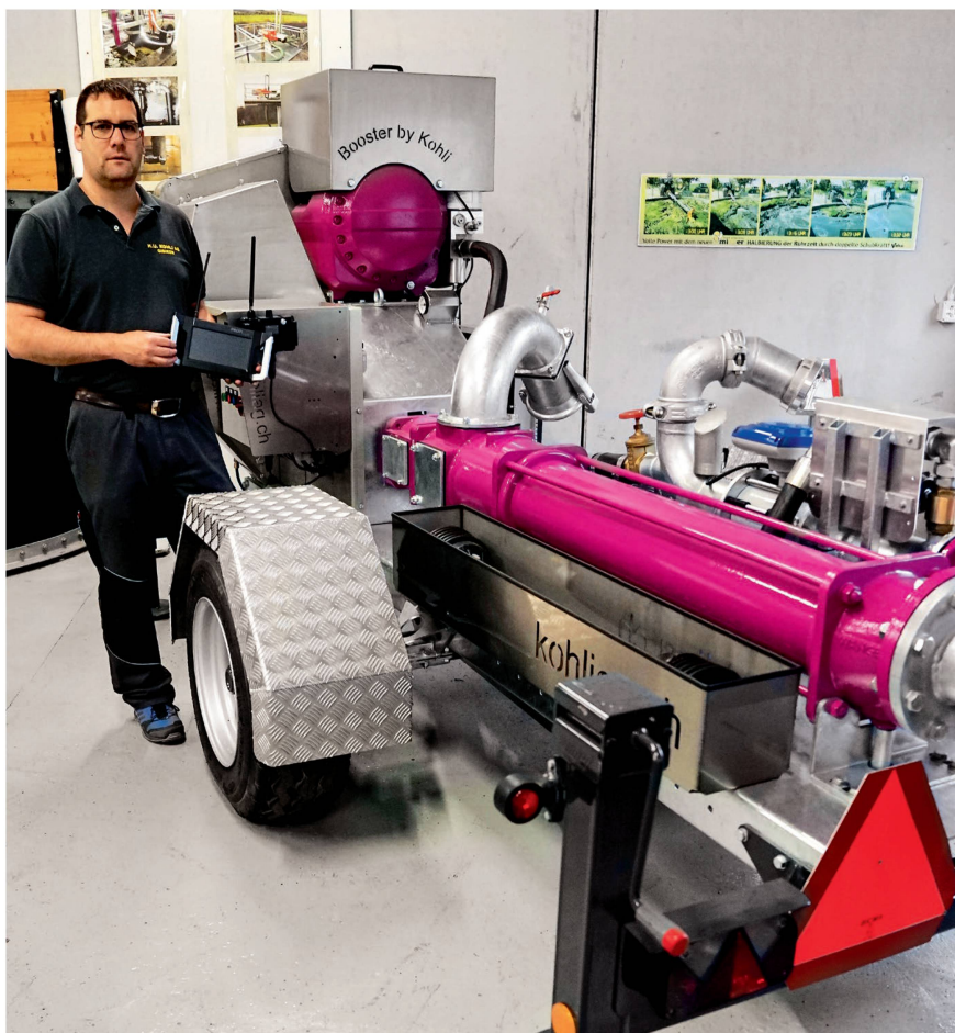
Les pompes à colimaçon de Kohli sont conçues pour des sollicitations maximales. Ici, elles sont équipées d'un surpresseur de fabrication maison permettant de purger les conduites.
