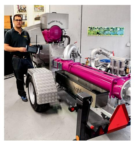
Les pompes à colimaçon de Kohli sont conçues pour des sollicitations maximales. Ici, elles sont équipées d'un surpresseur de fabrication maison permettant de purger les conduites.
