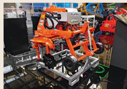
«Easyride» de Rinieri: système de positionnement automatique évaluant la distance de l'outil de désherbage mécanique par rapport à la rangée d'arbres. Un vérin hydraulique assure son déport transversal automatique.
