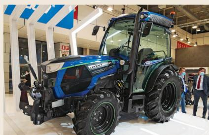
Tracteur hybride-électrique Landini «Rex 4»: un concept de tracteur «Rex 4» hybride-électrique avec transmission automatique, animé électriquement via l'essieu avant et dont la transmission peut être ajustée au besoin entre les essieux avant et arrière. Le véhicule présente ainsi un rayon de giration moindre. Il bénéficie d'une suspension de cabine semi-active contrôlée électriquement.
