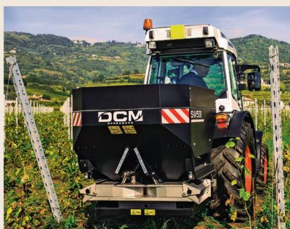
Distributeur d'engrais à double disques «SWS E» de DCM: application possible de doses d'engrais différencierées droite/gauche.
