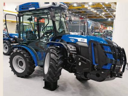
BCS «Dualsteer»: une combinaison d'orientation des roues avant et de direction articulée sur un tracteur à voie étroite, réduisant largement le rayon de giration.
