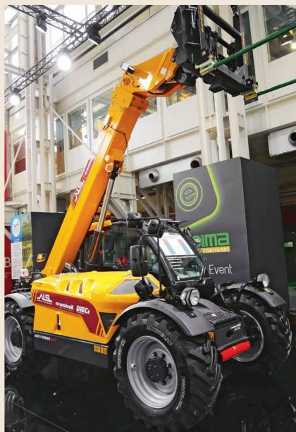
Le chariot télescopique «GD 42.7» de Dieci propose une détection de charge adaptative de Walvoil. Le circuit hydraulique est adapté de façon dynamique selon la charge, réduisant ainsi la consommation et améliorant l'utilisation de la puissance moteur.
