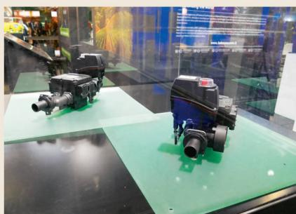
Débitmètre Arag «Orion WR»: une composante du système de contrôle d'un pulvérisateur comprenant deux circuits séparés, activés par le biais d'un vérin. Les constructeurs de pulvérisateurs peuvent ainsi concevoir différents circuits de répartition plus précis, plus réactifs et mieux adaptés à l'agriculture de précision.
