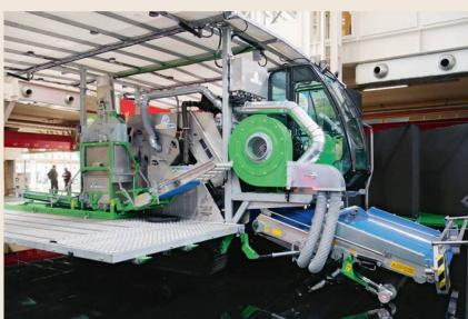
Le «Slide Ventum Trax» de Hortech peut récolter les légumes à petites feuilles. Ces produits sont acheminés dans des caisses à l'aide d'une turbine, les impuretés étant ainsi écartées. Les caisses sont par ailleurs constamment pesées, pour atteindre une répartition homogène de ces conteneurs.
