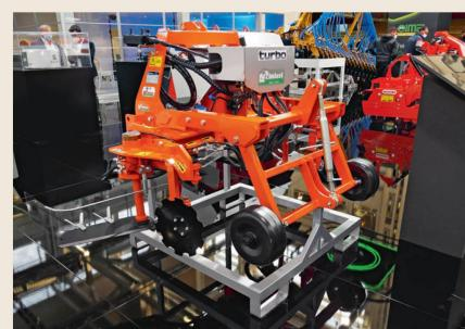
«Easyride» de Rinieri: système de positionnement automatique évaluant la distance de l'outil de désherbage mécanique par rapport à la rangée d'arbres. Un vérin hydraulique assure son dépôt transversal automatique.
