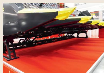
L'unité de coupe «Drago Gold» d'Olimac: conçue pour la récolte du tournesol, elle se compose d'un broyeur entraîné hydrauliquement pour hacher les tiges. Elle propose, au travers d'un dispositif hydraulique, différentes hauteurs de coupe des tiges et des capitules.
