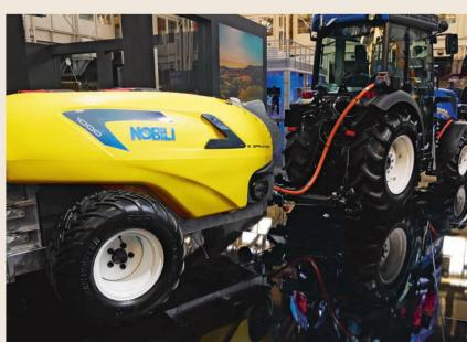
Nobili et CNH ont reçu une distinction pour leurs outils animés électriquement, tels que les pulvérisateurs arboricoles et les broyeurs, attelés à un tracteur à voie étroite qui embarque à l'avant un générateur de courant entraîné par la prise de force.
