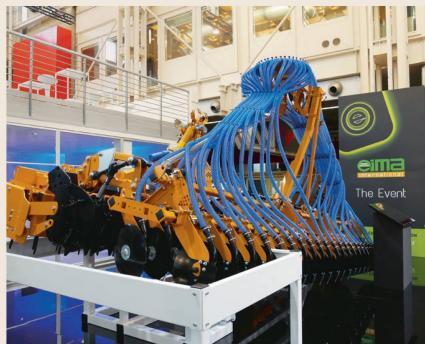
Tête de répartition Alpego «Horizon»: une tête de répartition électromécanique autonivelante pour semoir pneumatique, pour garantir une répartition régulière de la semence y compris dans les parcelles en pente.
