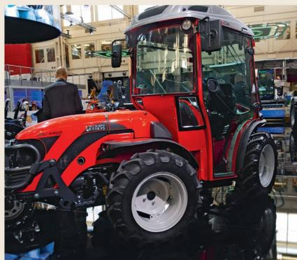
Tracteur spécialisé Antonio Carraro «SRX Tora»: malgré son passage aux normes anti-pollution de niveau 5 et l'intégration d'un filtre à particules, a pu conserver ses dimensions originales et ainsi toujours être adapté à la conduite dans les espaces étroits.
