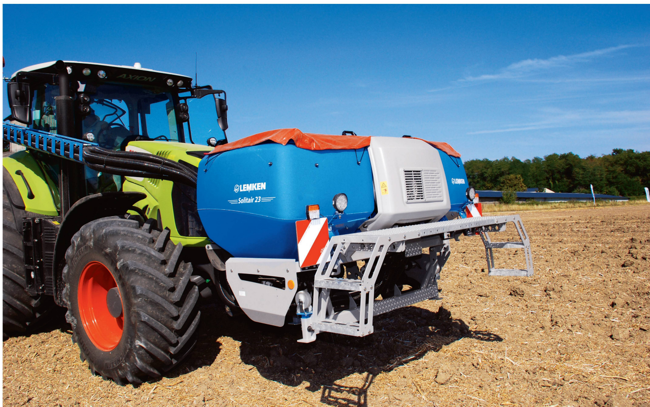
Le transport d'intrants intégrés à un appareil, comme ici la bouillie de traitement dans la cuve du pulvérisateur frontal, peut être considéré comme acceptable et non soumis à autorisation. Photo: Heinz Röthlisberger
