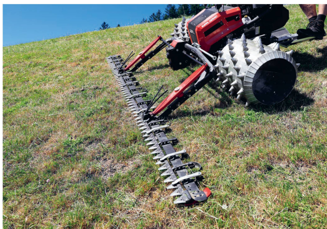
Les barres de coupe «KDSP» ont la particularité d'être fixées à gauche et à droite du châssis du porte-outil.
