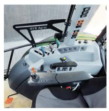
Le joystick progressif pour le chargeur frontal ou le relevage intégré dans l'accoudoir est réglable et peut s'utiliser tout en finesse.
