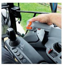
Ces deux boutons servent à sélectionner les rapports et les gammes sous charge. La «Hitech-4» offre 4 rapports et 4 gammes de changement de vitesse sous charge.
