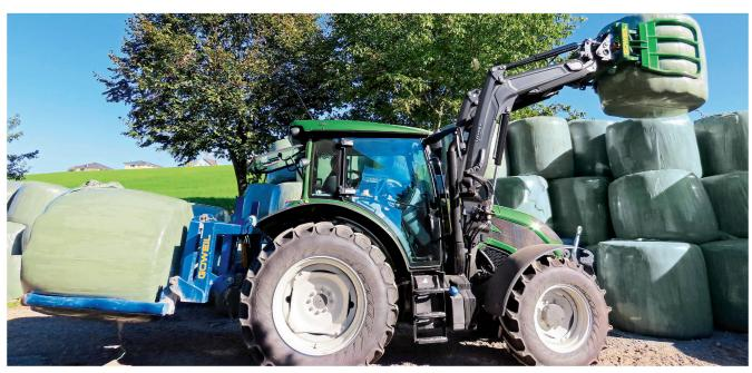
Le Valtra «A115 Hitech-4» est de construction compacte et dispose d'une technologie à la fois nouvelle et éprouvée. Ce tracteur, encore plus polyvalent, peut s'utiliser notamment pour le transport de balles d'ensilage. Photos: Martin Abderhalden
