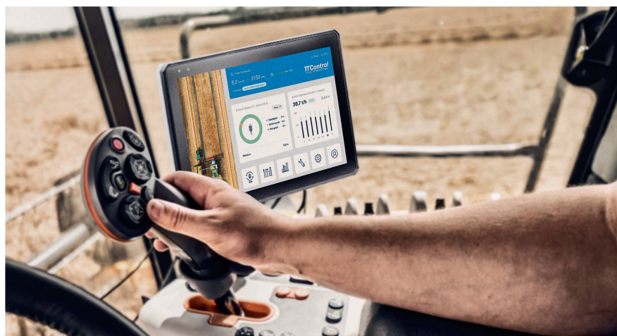
La dernière génération de l'afficheur de TTControl peut être intégrée dans une architecture de véhicules complexe grâce à ses très nombreuses interfaces. Photo: TTControl
