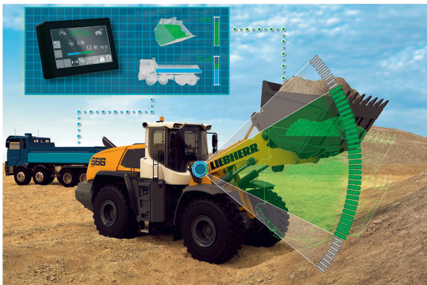
Dans le cas du dispositif de pesage «Truck Payload Assist» de Liebherr, la plage de pesage s'adapte automatiquement aux besoins de l'application. Photo: Liebherr
